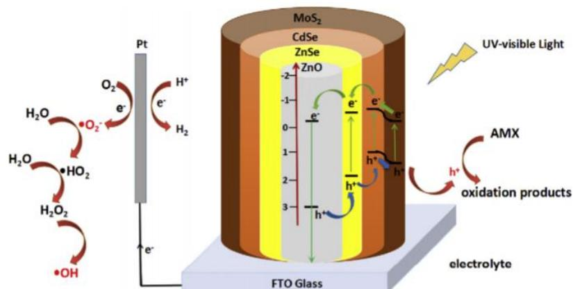
**Slika 5.2.** Mehanizam oksidacije u procesu fotoelektrokatalize
