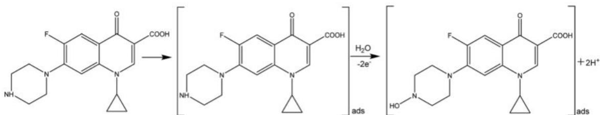
**Slika 5.1.** Elektrokemijska razgradnja CIP na GC RDE elektrodi. [23]
