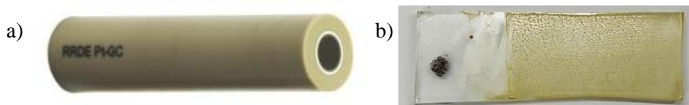
**Slika 3.2.** Radne elektrode a) GC elektroda b)  $\text{TiO}_2/\text{SnS}_2$  elektroda.
