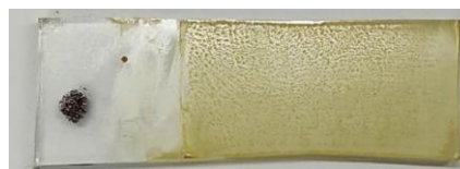
Slika 3.2. Radne elektrode a) GC elektroda b) \text{TiO}_2/\text{SnS}_2 elektroda.
