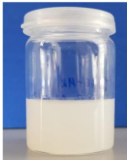
**Slika 17.b** Vizualna metoda određivanja stabilnosti NS-a (7. dan)
