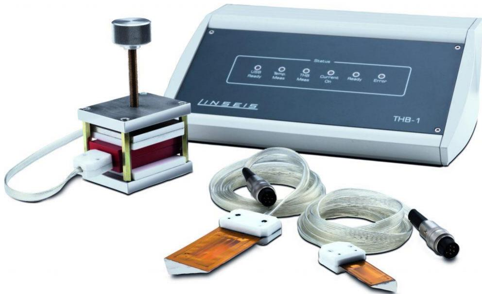
**Slika 14.** *Transient Hot Bridge (THB) Thermal Conductivity Meter* za mjerjenje toplinskih svojstava DES-a
