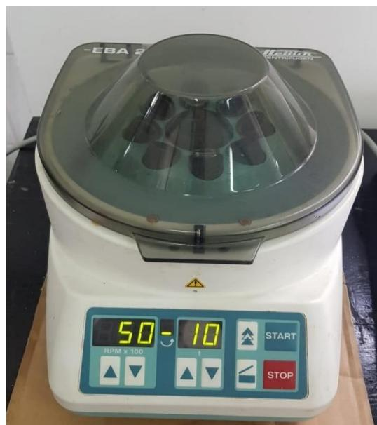
**Slika 12.a** Centrifuga *Centric 32AA (Tehnica)* za određivanje stabilnosti NS-a
