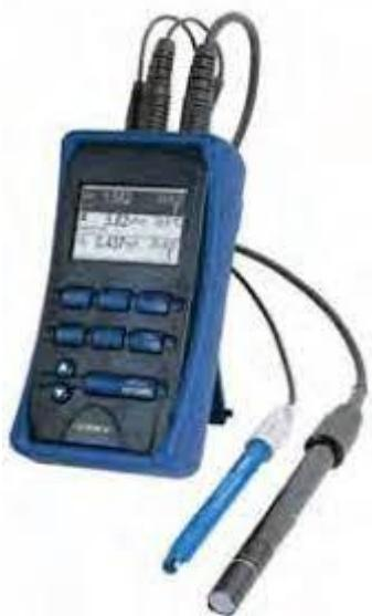
**Slika 13.c** WTW InoLab pH/Cond 740 (*pH electrode SenTix 81 i konduktometrijska elektroda: WTW Tetracon 325*) za mjerjenje pH i električne vodljivosti NS-a i DES-a
