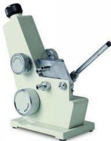
Slika 13.d Abbeovom refraktometru RMI, Optech za mjerenje indeksa loma NS-a i DES-a
