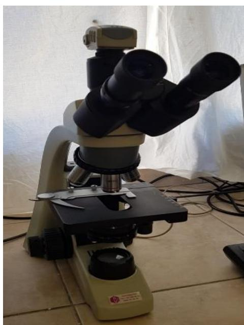
**Slika 12.b** Mikroskop *Motic BA200* za određivanje stabilnosti NS-a
