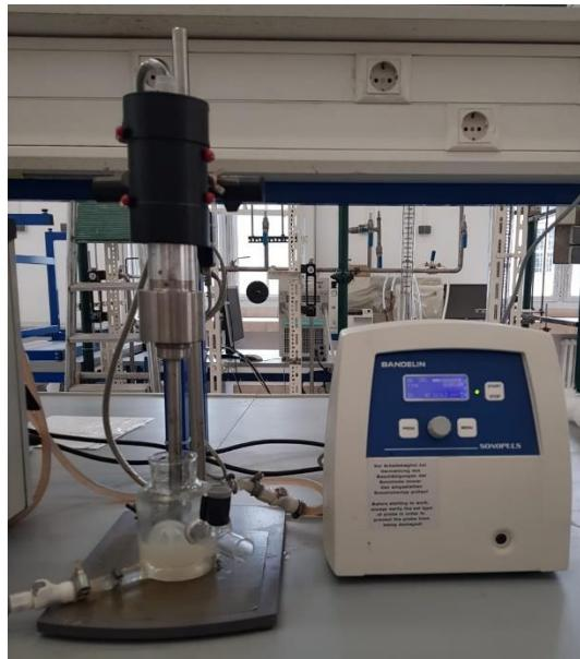
**Slika 11.** Ultrazvučni homogenizator *Bandelin sonoplus HD 3200*
