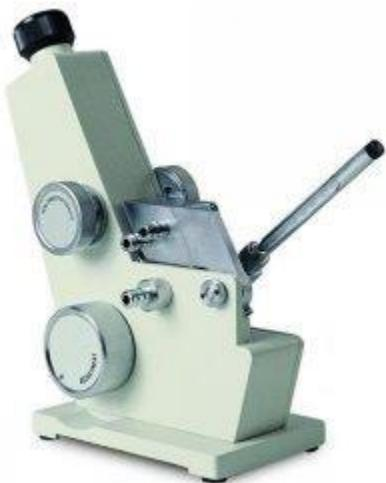
**Slika 13.d** *Abbeovom refraktometru RMI, Optech* za mjerjenje indeksa loma NS-a i DES-a
