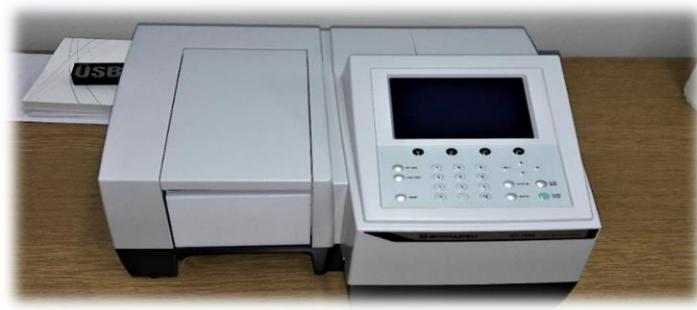
**Slika 20.** UV/Vis-spektrofotometar Shimadzu UV-1280
