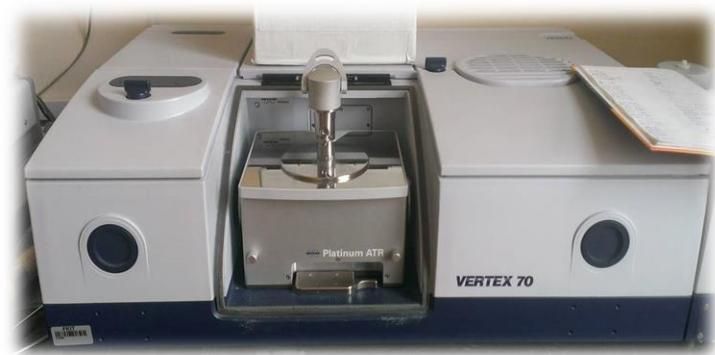
**Slika 15.** Fotografija FTIR spektrofotometra Vertex 70 s platinastim detektorom
