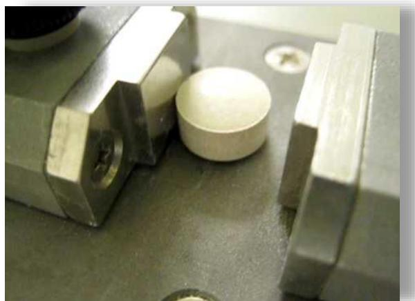
**Slika 18.** Fotografija uređaja za mjerjenje tvrdoće tableta
