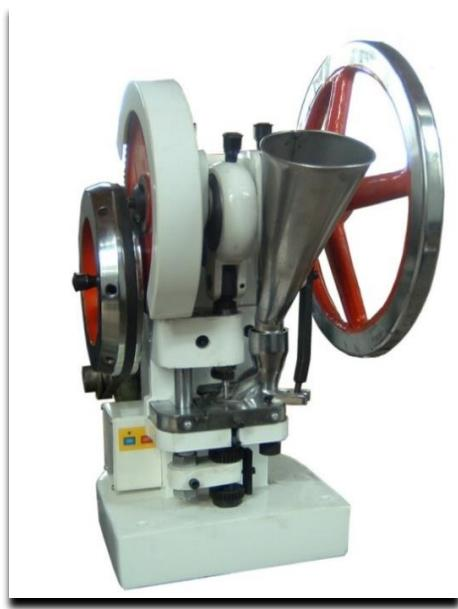
**Slika 11.** Fotografija uređaja za tabletiranje TDP-5T
