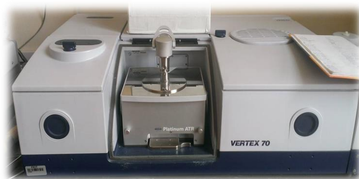
Slika 15. Fotografija FTIR spektrofotometra Vertex 70 s platinastim detektorom (Bruker, Billerica, SAD)
