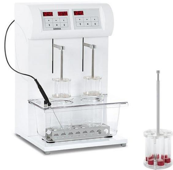
**Slika 19.** Fotografija uređaja za ispitivanje raspadljivosti tableteta ZT 322
