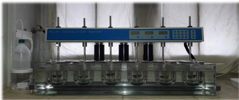
**Slika 21.** Fotografija uređaja za ispitivanje oslobađanja djelatne tvari RC-6D
