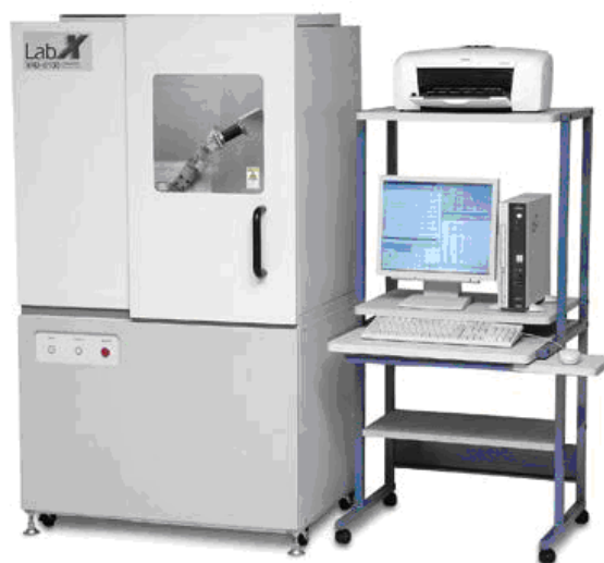
Slika 16. Fotografija uređaja za rendgensku difrakcijsku analizu praha XRD-6300 (Shimadzu, Kyoto, Japan)
