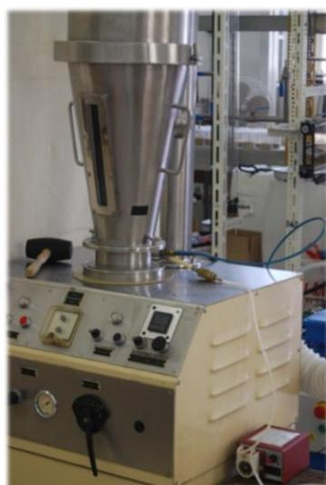
**Slika 10.** Fotografija granulatora s fluidiziranim slojem Uni-Glatt
