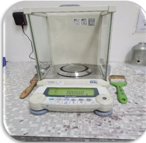
Slika 3.3. Analitička vaga Shimadzu
