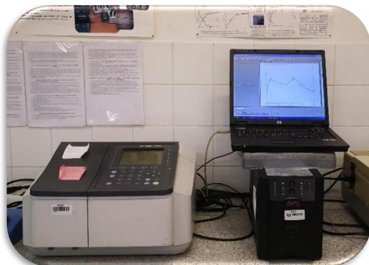
*Slika 3.1. Spektrofotometar Shimadzu UV-1800*
