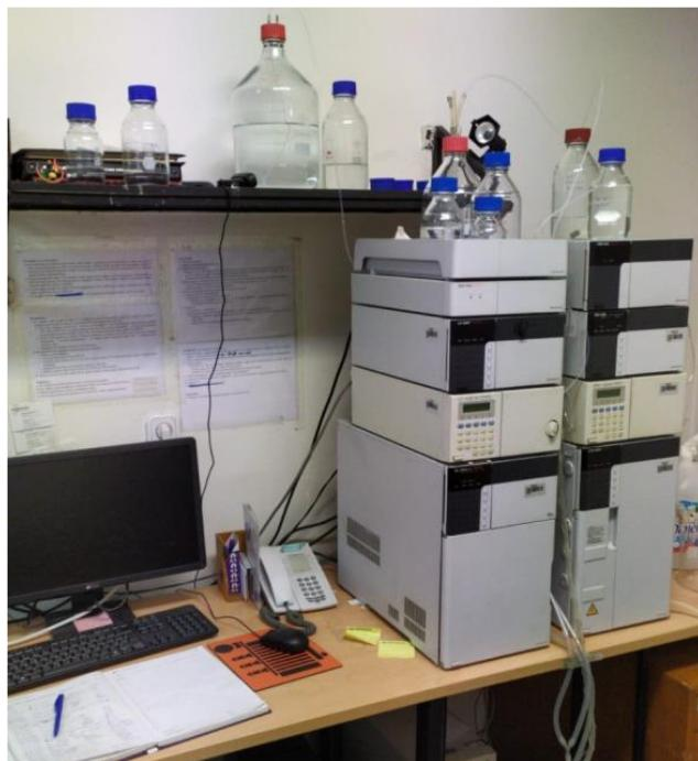
**Slika 19.** HPLC s UV detektorom, Shimadzu (Japan)
