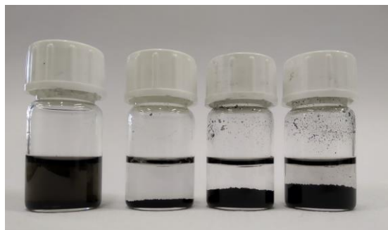
Slika 17. Nemodificirane MWCNT u MQ vodi sa SOLSPERSE stabilizatorom početne koncentracije 0,5, 1, 3 i 10 mg mL -1 , fotografirano 2 dana nakon homogeniziranja.
