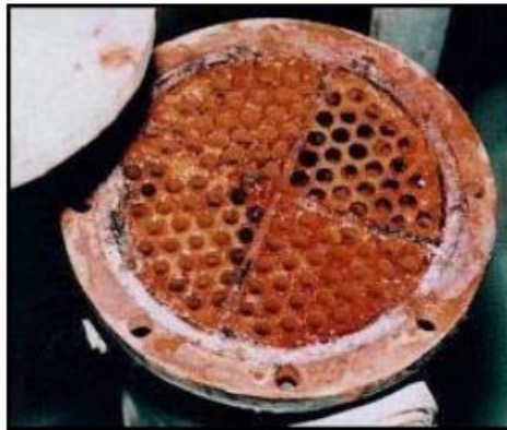
Slika 5. Zaprljani izmjenjivač topline [6]
