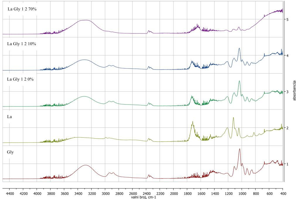
**Slika 28.** Usporedba FTIR-a za La, Gly te DES La:Gly (1:2) s masenim udjelima vode
