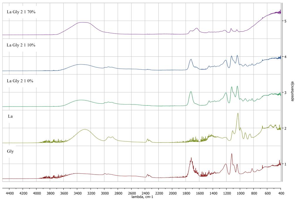
**Slika 27.** Usporedba FTIR-a za La, Gly te DES La:Gly (2:1) s masenim udjelima vode
