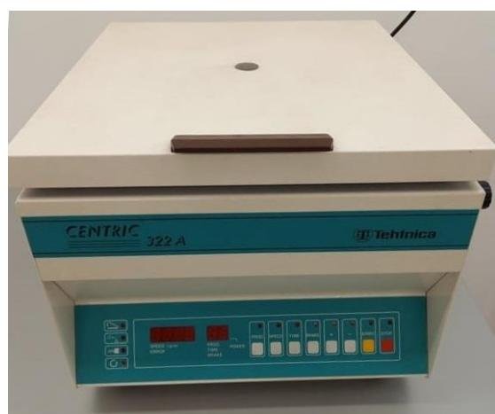
**Slika 18.** Centrifuga *Tehnica Centric 322A*
