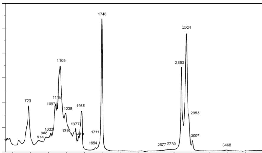
Slika 8. Spektrogram maslinovog ulja dobiven pomoću FTIR-a [53]
