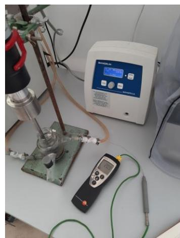
**Slika 16.** Ultrazvučna sonda, *Bandelin sonoplus HD 3200*
