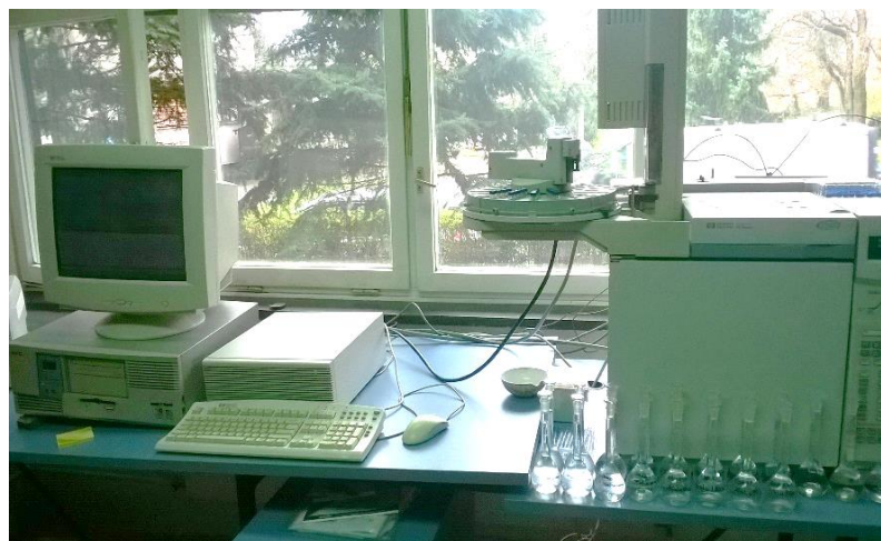
Slika 16. Plinski kromatograf HP Agilent 6890 Series
