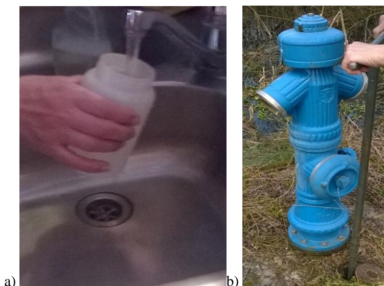
Slika 14. Načini uzorkovanja vode: a) iz slavine, b) na hidrantu
