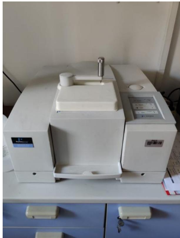
Slika 18. PerkinElmer Spectrum One infracrveni spektrofotometar s Fourierovom transformacijom signalata
