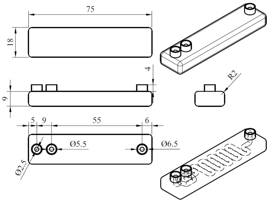
Slika 10. Shematski prikaz vanjskih dimenzija cijevnog milireaktora
