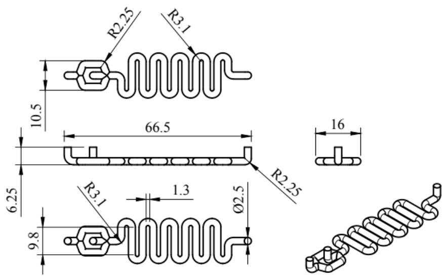
Slika 11. Shematski prikaz reakcijskog prostora cijevnog milireaktora
