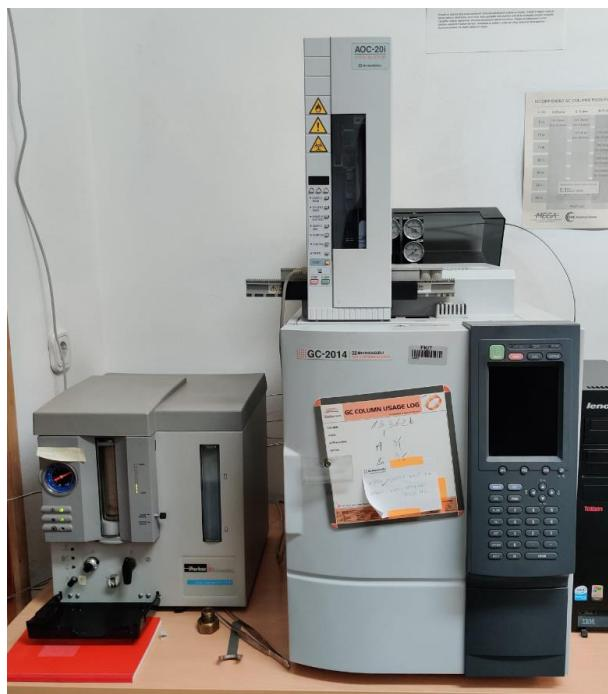
Slika 17. Plinski kromatograf Shimadzu GC-2014 s FID detektorm
