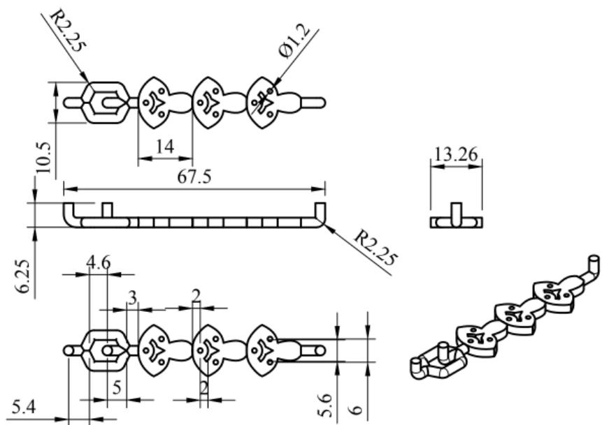
Slika 13. Shematski prikaz reakcijskog prostora milireaktora sa statičkim miješalicama oblika modificirane gljive
