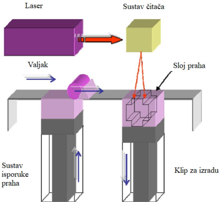
Slika 4. Dijelovi SLS 3D-pisača [15]
