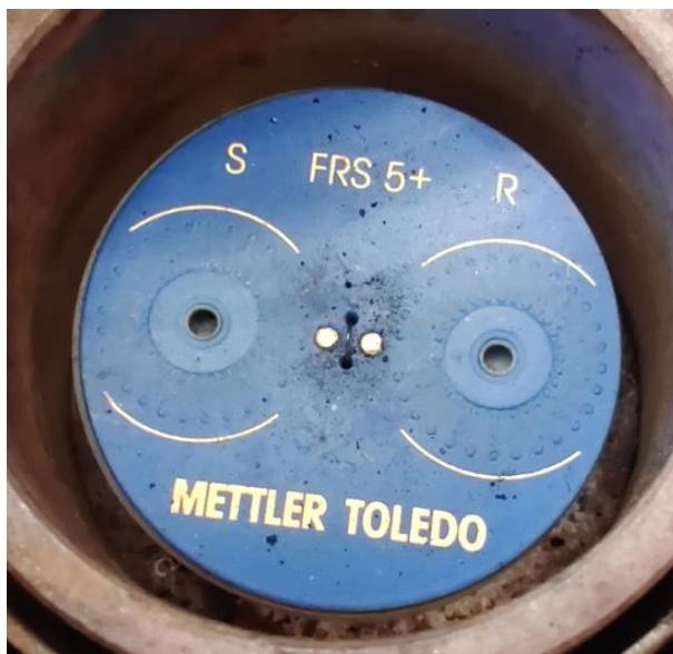
Slika 23. Mjerno osjetilo FRS 5+
