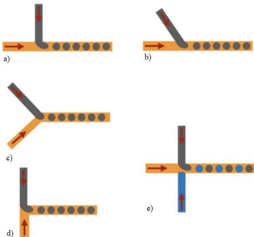
Slika 6. Primjeri spojnica: a) Y spojница b) i c) T spojница, d) *head-on* spojница i e) alternirajuća spojница [19]
