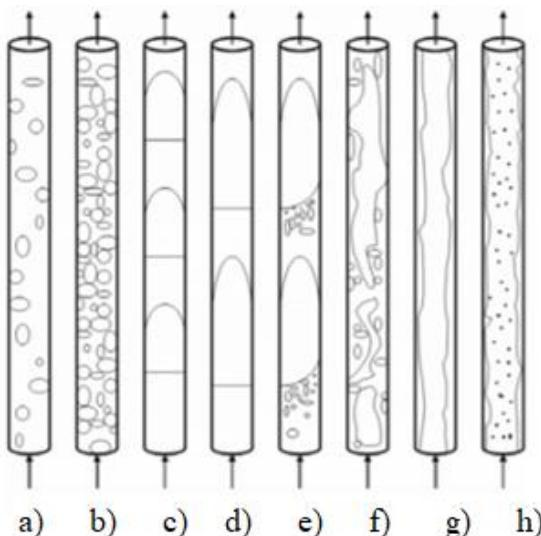
Slika 7. Strujanje fluida: (a,b) mjehurićasto strujanje, (c, d) segmentirano (Taylorovo) strujanje, (e) prijelazno segmentirano – užburkano stanje, (f) užburkano strujanje, (g) strujanje u filmu, (h) anularno strujanje [21]
