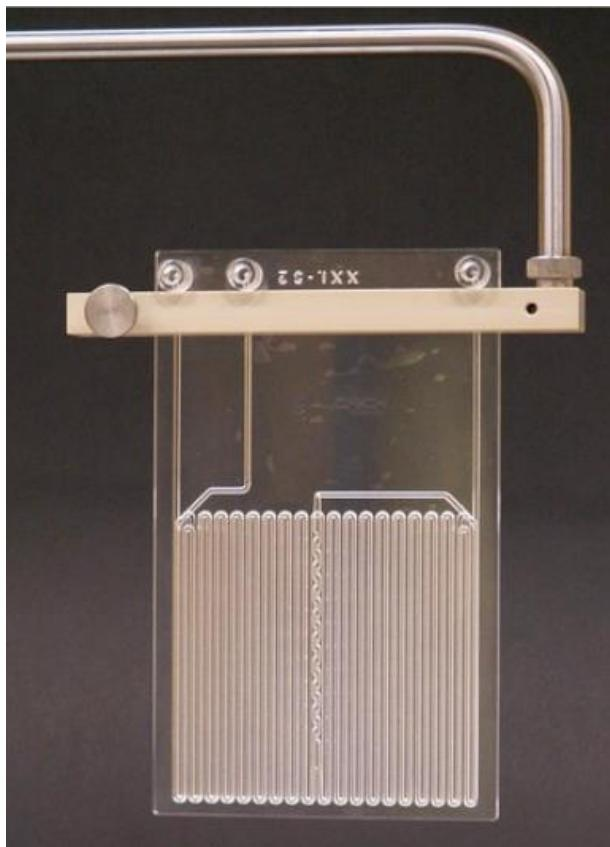
Slika 8. Primjer mikroreaktora izgrađenog od stakla [25]
