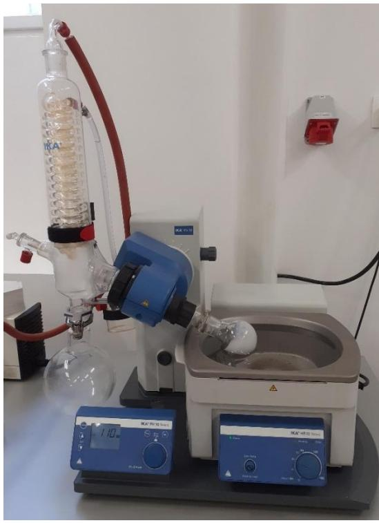
**Slika 10.** Vakuum isparivač *IKA RV 10 basic*.
