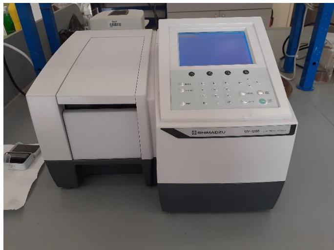
Slika 15. UV/VIS spektrofotometar (*UV-1280*) *SHIMADZU*.
