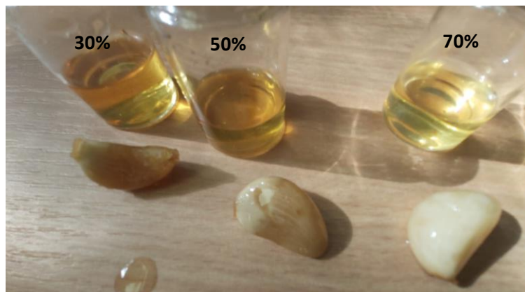
Slika 32. Češnjak iz uzoraka NADES-a nakon tri mjeseca ispitivanja.
