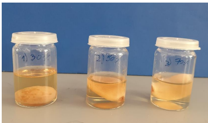
Slika 30. Češnjak u uzorcima NADES-a nakon dva mjeseca ispitivanja.
