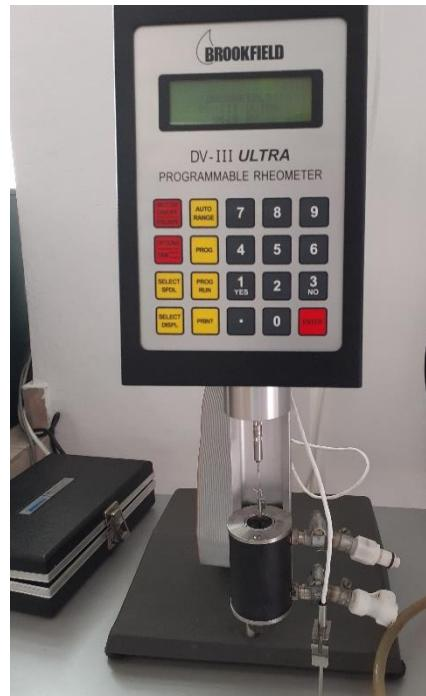
**Slika 13.** *Brookfield DV-III ULTRA* reometar za određivanje viskoznosti.
