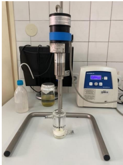
Slika 11. Ultrazvučna sonda (Bandelin Sonoplus HD 3100, Njemačka)
