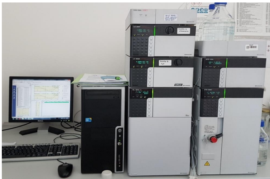
Slika 12. Uređaj za tekućinsku kromatografiju visoke djelotvornosti (HPLC uređaj)
