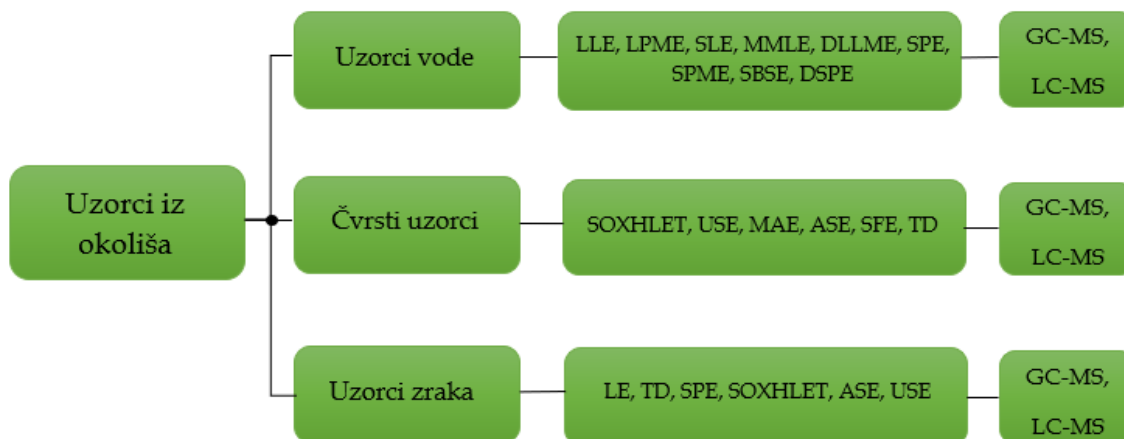
Slika 2. Shematski prikaz uobičajenog postupka analize ftalata iz različitih uzoraka okoliša
