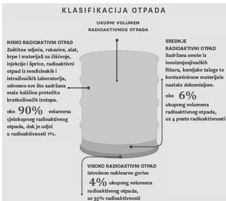
**Slika 5.1. Klasifikacija radioaktivnog otpada (8)**
