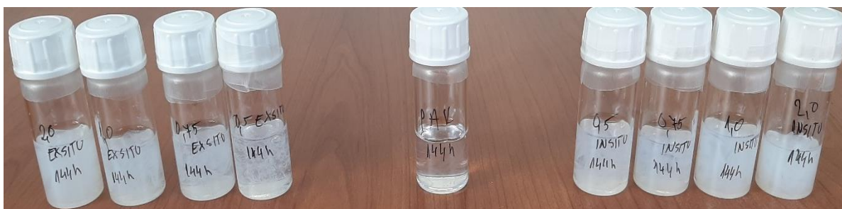
Slika 35. Neotopljeni PAK i PAK/TiO 2 ex situ i in situ filmovi u THF-u nakon 144 sata UV zračenja
