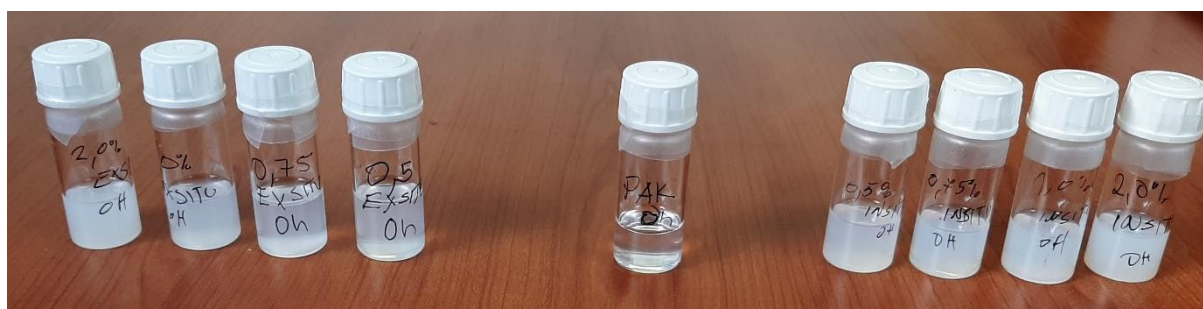
Slika 32. Otopljeni PAK i PAK/TiO 2 ex situ i in situ filmovi u THF-u prije UV zračenja
