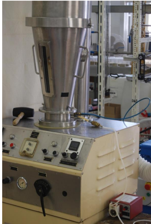
Slika 4.13. Fotografija granulatora s fluidiziranim slojem Uni-Glatt (Glatt GmbH, Binzen, SR Njemačka).
