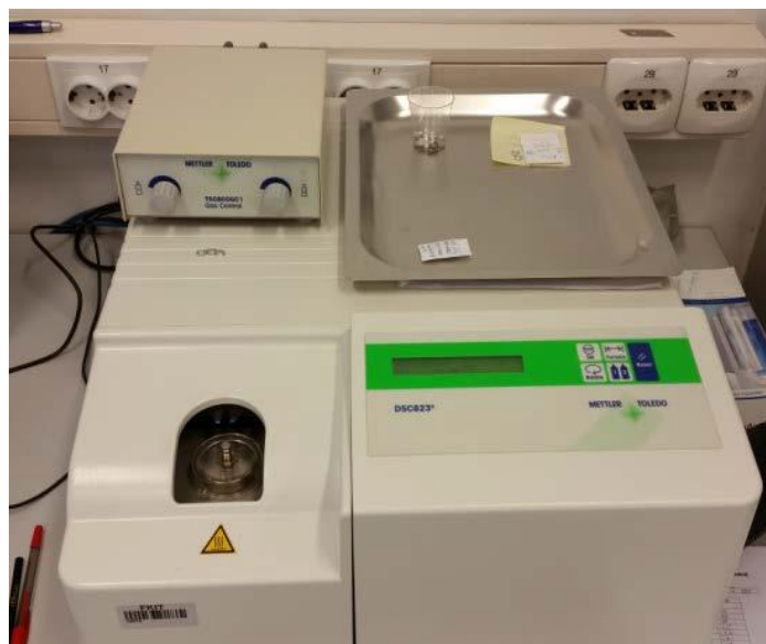
Slika 4.16. Diferencijalni pretražni kalorimetar Mettler Toledo 822° (Mettler Toledo GmbH, Greifensee, Švicarska).
