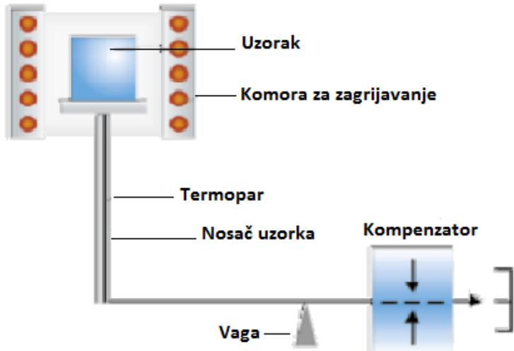
Slika 7. Shematski prikaz TGA instrumenta
