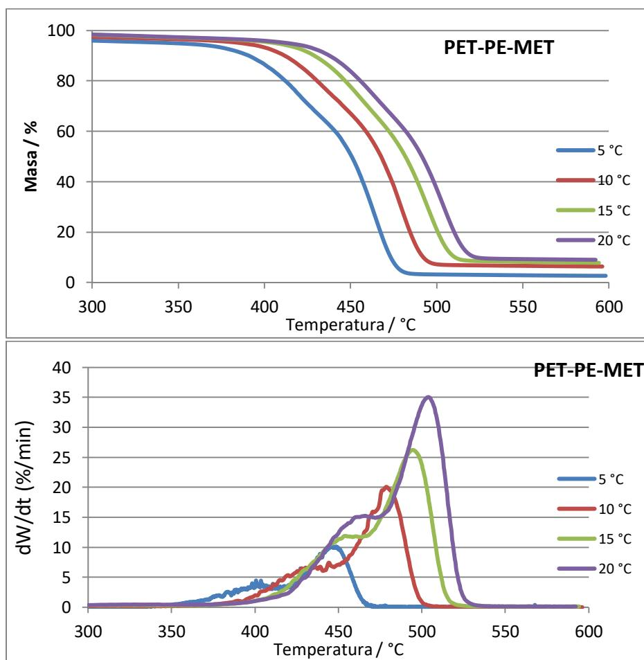
Slika 4.5. a)TG i b)DTG krivulje za PET-PE-met pri brzinama zagrijavanja 5,10,15 i  $20\text{ }^{\circ}\text{C}/\text{min}$
