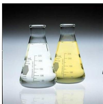
**Slika 11.** Prikaz Fischer-Tropsch dizela (lijevo) i mineralnog dizela(desno).<sup>38</sup>
