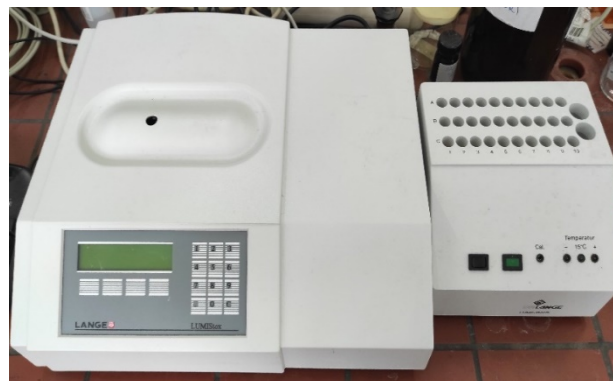
Slika 20. Hach Lange LUMIStox 300 luminometar
