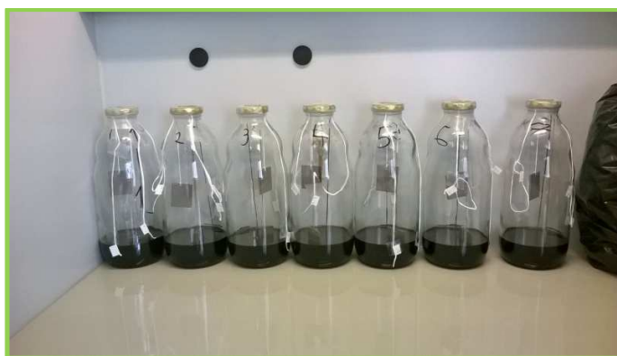
Slika 3.3. Uzorci izloženi korozivskom djelovanju tijekom 90 dana na sobnoj temperaturi.
