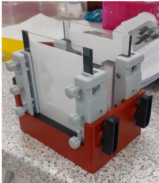
**Slika 10.** Aparatura za elektroforezu
