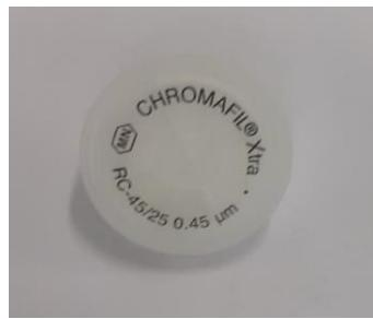
*Slika 8.* Filter CHROMAFIL® Xtra, RC-45/25 0.45 μm
