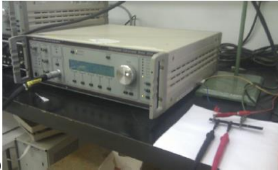
Slika 40. a) Instrument za puštanje struje određene jakosti, b) voltametar i električni krug na uzorku, spajan prema metodi četiri kontakta (slika 34.)
