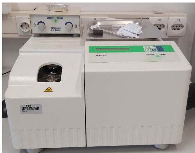
Slika 19. Uređaj Mettler Toledo DSC 823.
