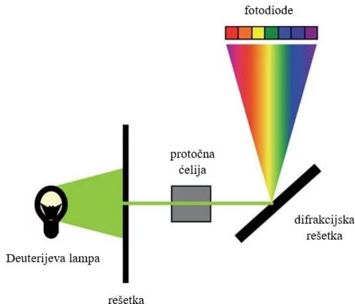
**Slika 13.** Shematski prikaz detektora s nizom dioda [36]
