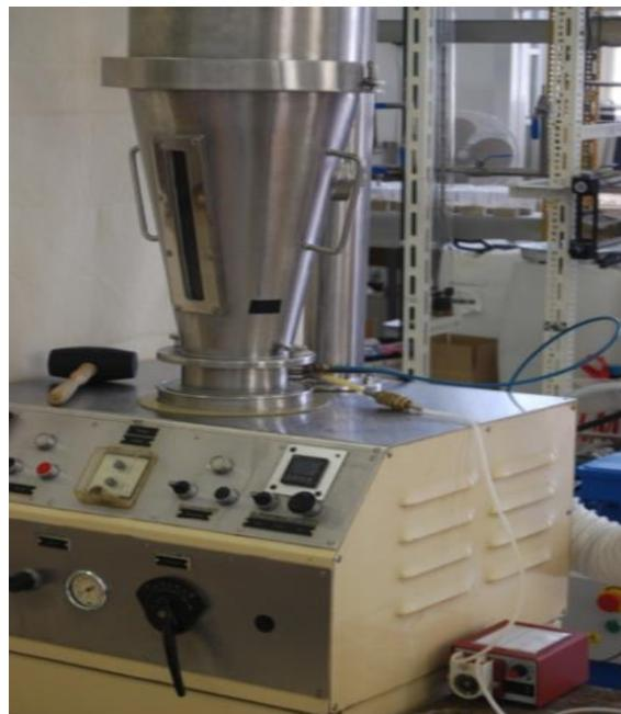
**Slika 10.** Fotografija granulatora s fluidiziranim slojem Uni-Glatt
