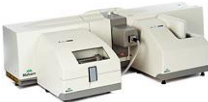
**Slika 13. Fotografija uređaja za određivanje raspodjele veličina čestica metodom laserske difrakcije MASTERSIZER 2000<sup>22</sup>**
