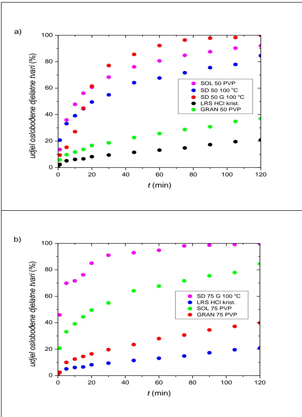
**Slika 20.** Eksperimentalno dobiveni profili oslobađanja djelatne tvari za uzorke čvrstih disperzija: a) s omjerom LRS HCl-a i PVP-a 1:1 b) s omjerom LRS HCl-a i PVP-a 3:1
