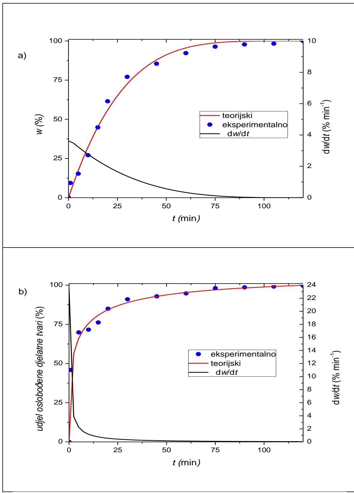
**Slika 22.** Profili oslobođanja i funkcija brzine oslobođanja LRS HCl-a, uzoraka čvrstih disperzija pripravljenih metodom sušenja raspršivanjem s dodatkom granulata pri 100 °C:
