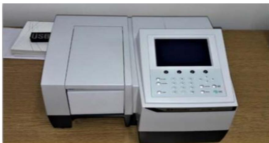
**Slika 15.** Spektrofotometar UV-1280
