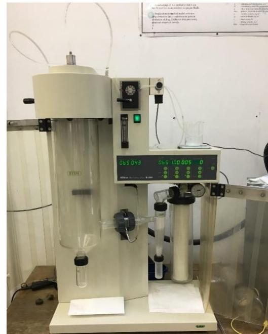
**Slika 12.** Laboratorijski sušionik s raspršivanjem (BÜCHI Mini Spray-Dryer B-290)
