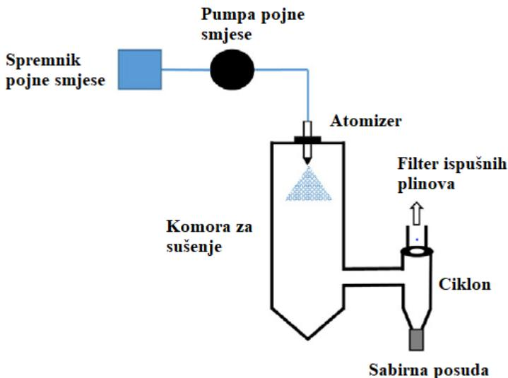
**Slika 7.** Shematski prikaz procesa priprave amorfnih čvrstih disperzija metodom sušenja raspršivanjem.
