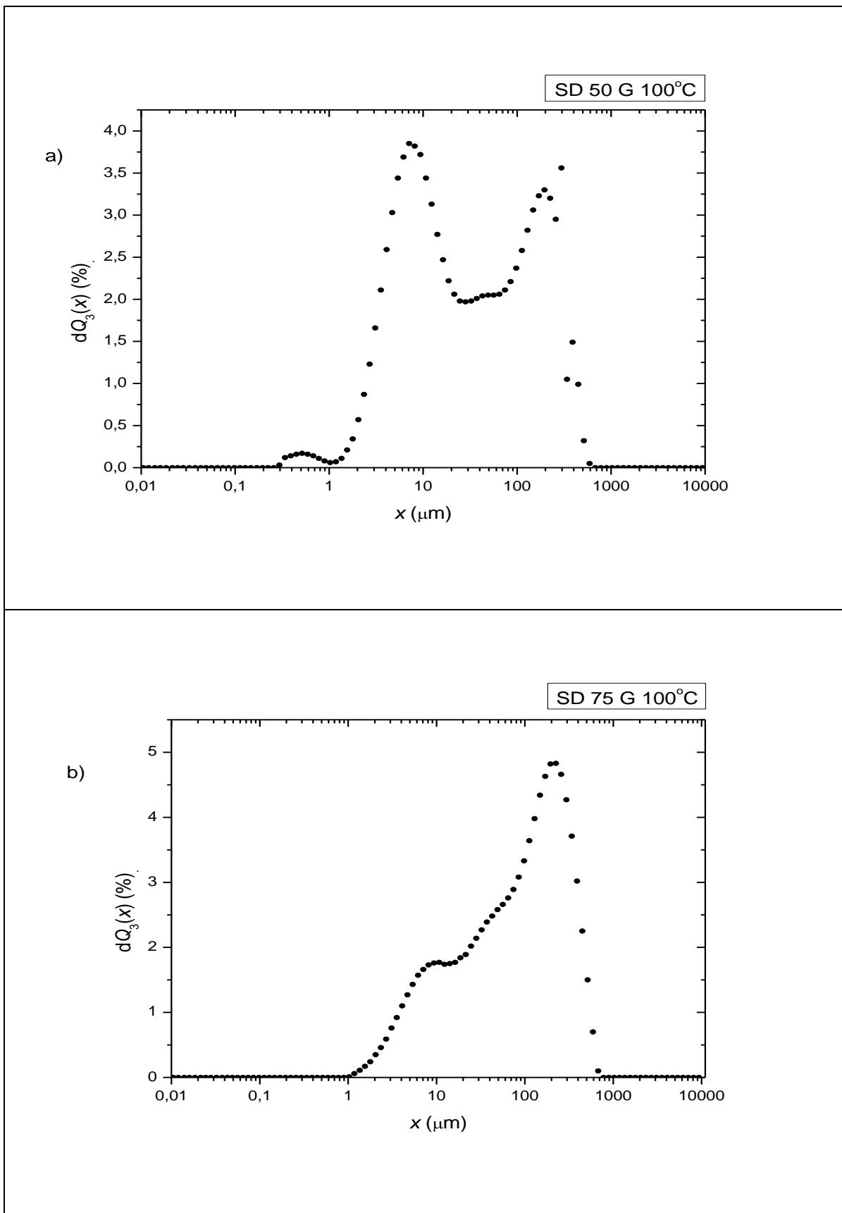
**Slika 17.** Diferencijalna raspodjela veličina čestica uzoraka čvrstih disperzija pipravljenih metodom sušenja raspršivanjem uz dodatak granulata pri  $100^{\circ}\text{C}$ :
