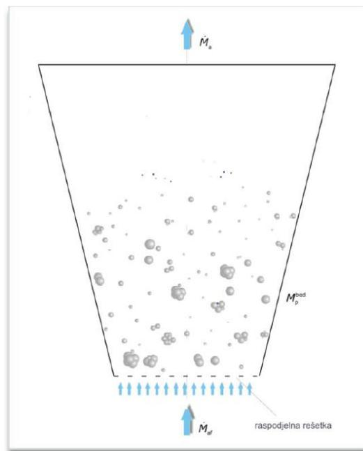
**Slika 6.** Shema procesnog prostora u tehnologiji granuliranja u fluidiziranom sloju taljenjem sa in-situ dodanim vezivom<sup>10</sup>
