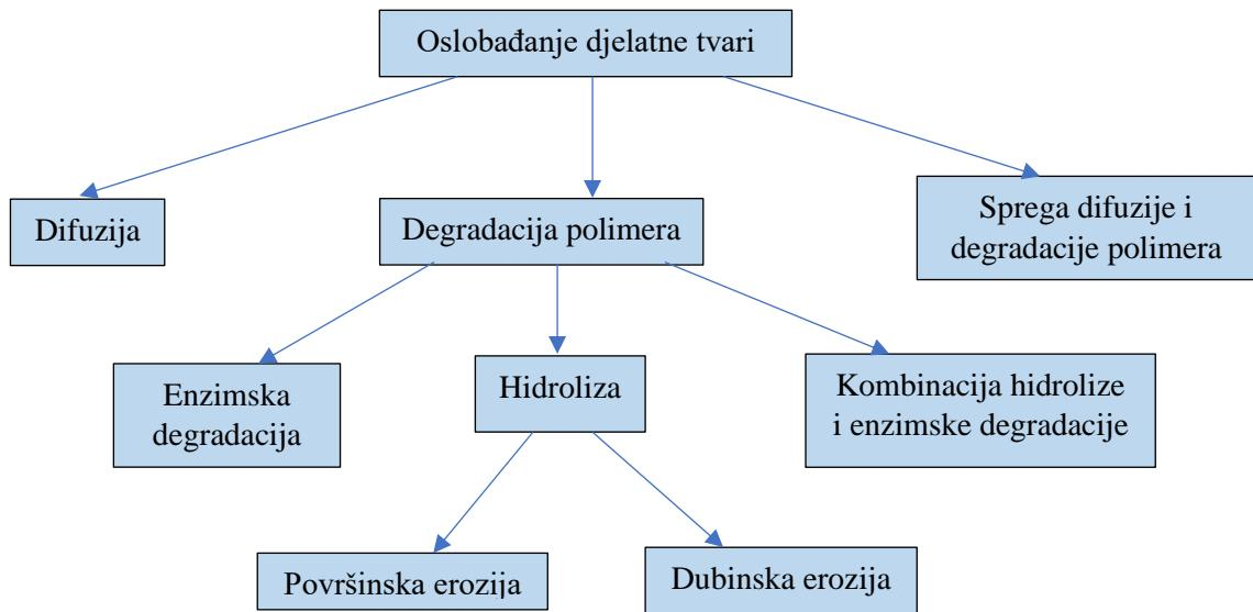
**Slika 8.** Shematski prikaz mehanizama oslobođanja djelatne tvari
