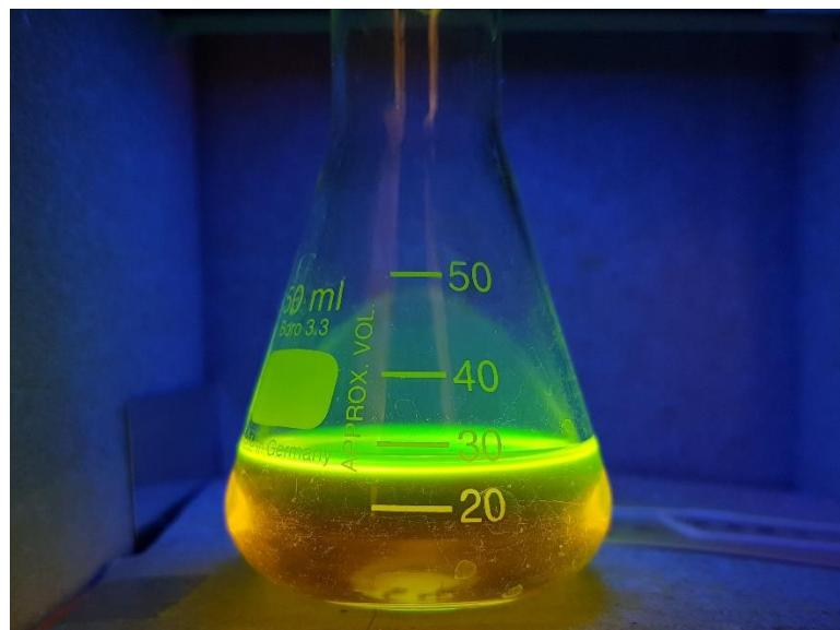
**Slika 4.** Otopina BODIPY spoja u  $\text{CH}_2\text{Cl}_2$  osvijetljena UV-svjetlom  $\lambda = 366 \text{ nm}$
