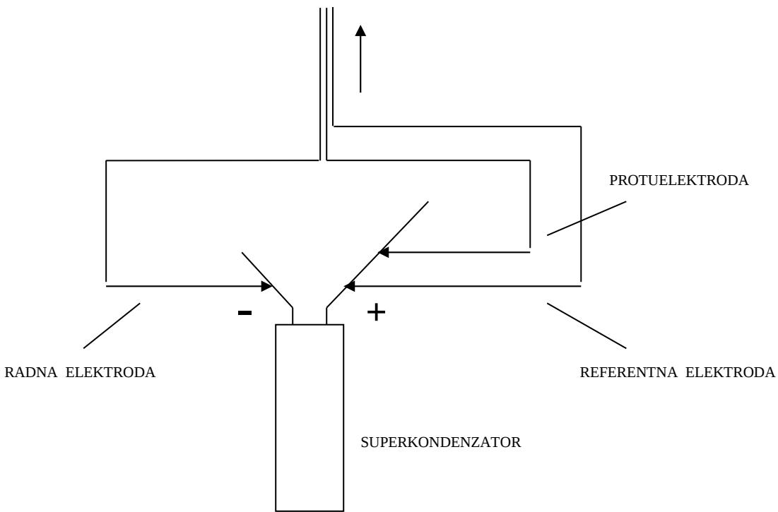
Slika 3.3 Shema dvoelektrodnog sustava sa ispitivanim komercijalnim superkondenzatorom
