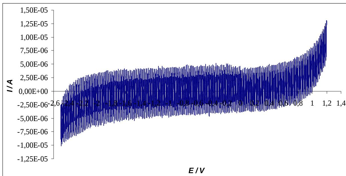
Slika 4.3. Ciklički voltamogram za Al elektrodu u  $0,1\text{ M}$  otopini  $\text{LiPF}_6$  u otapalu propilen karbonatu
