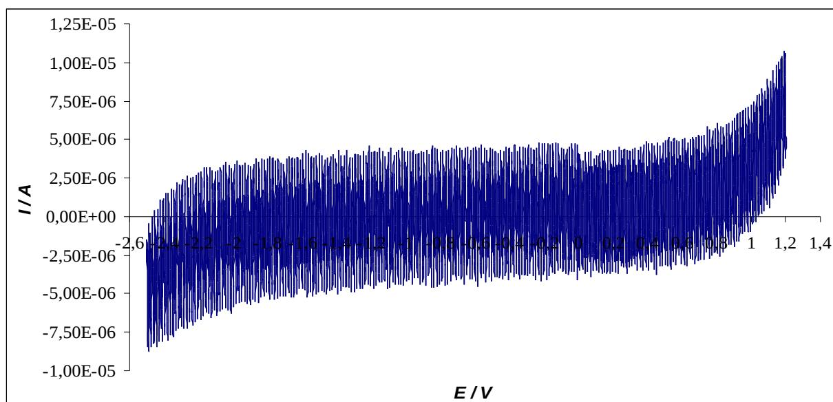
Slika 4.4. Ciklički voltamogram za Al elektrodu u  $0,1\text{ M}$  otopini  $\text{LiPF}_6$  u smjesi otapala propilen karbonata i etilen karbonata koji su pomiješani u volumnom omjeru 50:50
