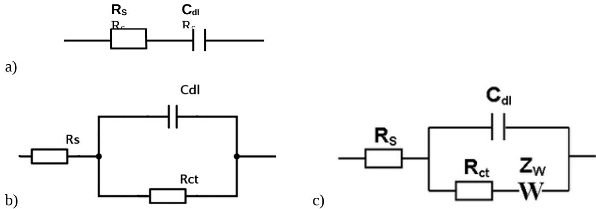
Slika 2.19 Prikaz ekvivalentnog električnog kruga za a) serijski spoj otpora elektrolita i kapaciteta električnog dvosloja, b) Randlesov električni krug  $R(RC)$ , c) Randlesov električni krug s Warburgovim elementom ( $W$ )
