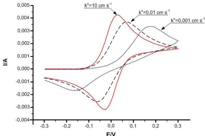
Slika 2.16 Ciklički voltamogrami za različite konstante brzine prijenosa elektrona ( $k^o$ )
