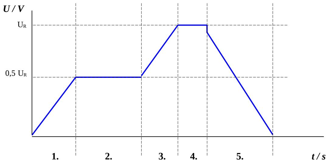
Slika 3.7 Napon-vrijeme karakteristika u kronopotenciometrijskom mjerenu za energetsku učinkovitost. Brojevima 1, 2 i 3 dani su koraci koji se odvijaju prilikom mjerenu; 1 – galvanostatsko punjenje od 0 V do 0,5  $U_R$ , 2 – potenciostatsko punjenje pri 0,5  $U_R$ , 3 – galvanostatsko punjenje od 0,5  $U_R$  do  $U_R$ , 4 - potenciostatsko punjenje pri  $U_R$ , 5 – galvanostatsko pražnjenje do 0 V
