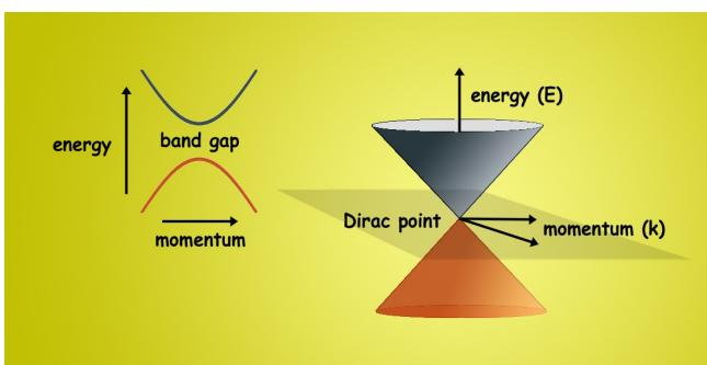
Slika 2.9 *Elektronske vrpce; valentna (crveno) i vodljiva (crno) u poluvodiču (lijevo) i u grafenu (desno). Elektronske vrpce grafena (tzv. Diracovi konusi) se na svakom C atomu dodiruju u Diracovoj točki*
