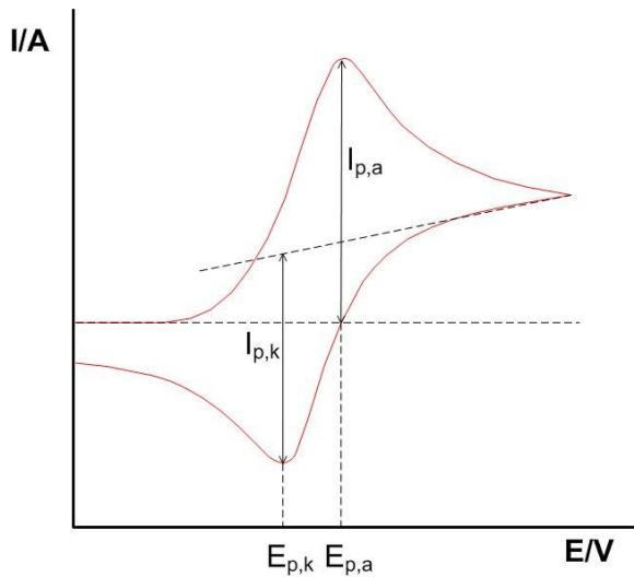
Slika 2.14 Ciklički voltamogram za reverzibilni elektrodni proces
