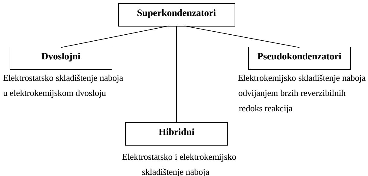
Slika 2.4 Vrste superkondenzatora te osnovni principi na kojima skladište naboј
