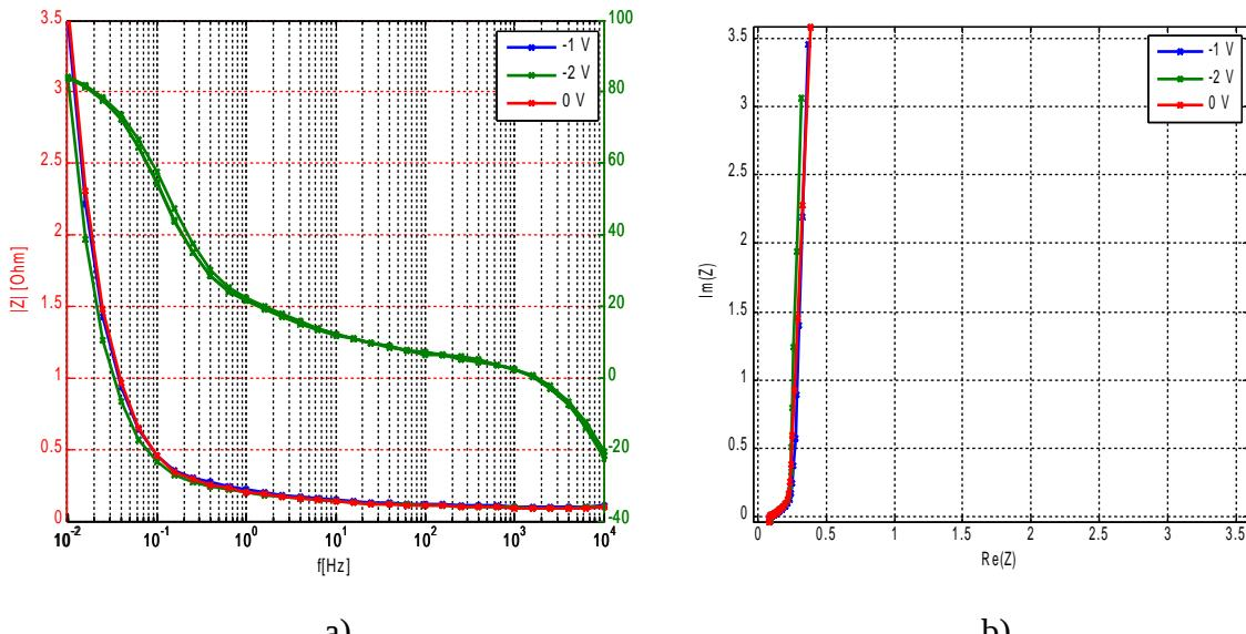
Slika 4.15a-b *Rezultati ispitivanja metodom elektrokemijske impedancijske spektroskopije (EIS) prikazani Bodeovim (lijevo) i Nyquistovim (desno) dijagramom pri 0 °C*
