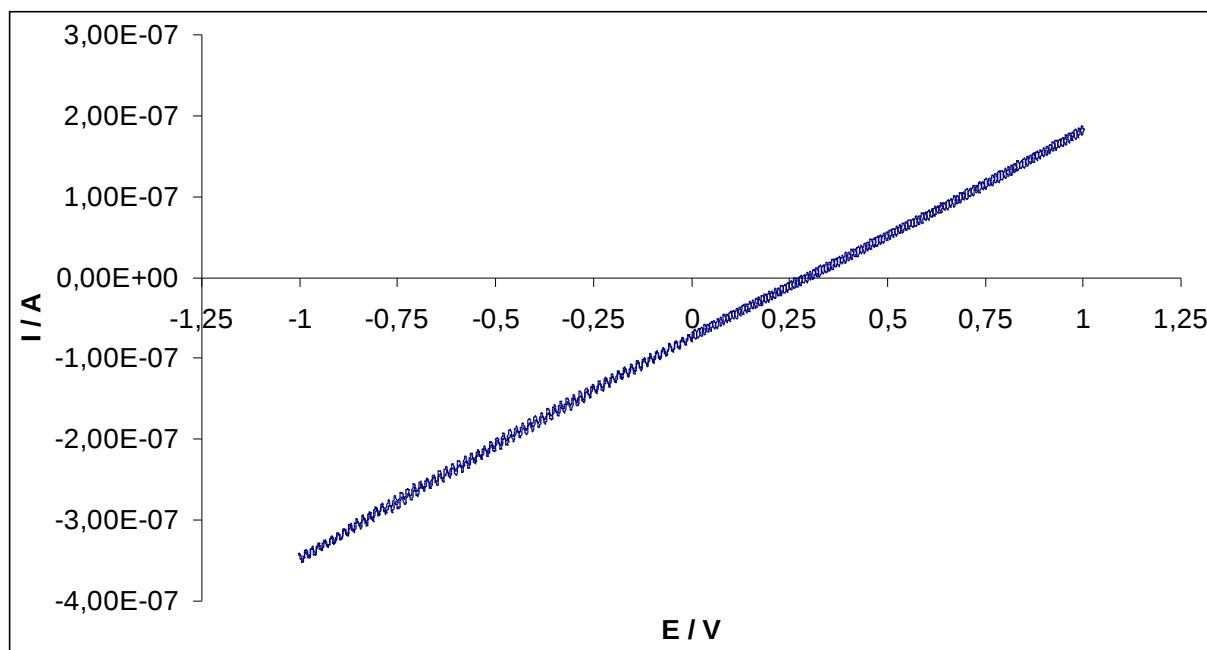
Slika 4.6 Ciklički voltamogram za elektrodu sa pripremljenim kompozitom u 0,1 M otopini  $\text{LiBF}_4$  u smjesi otapala propilen karbonata i etilen karbonata koji su pomiješani u volumnom omjeru 50:50
