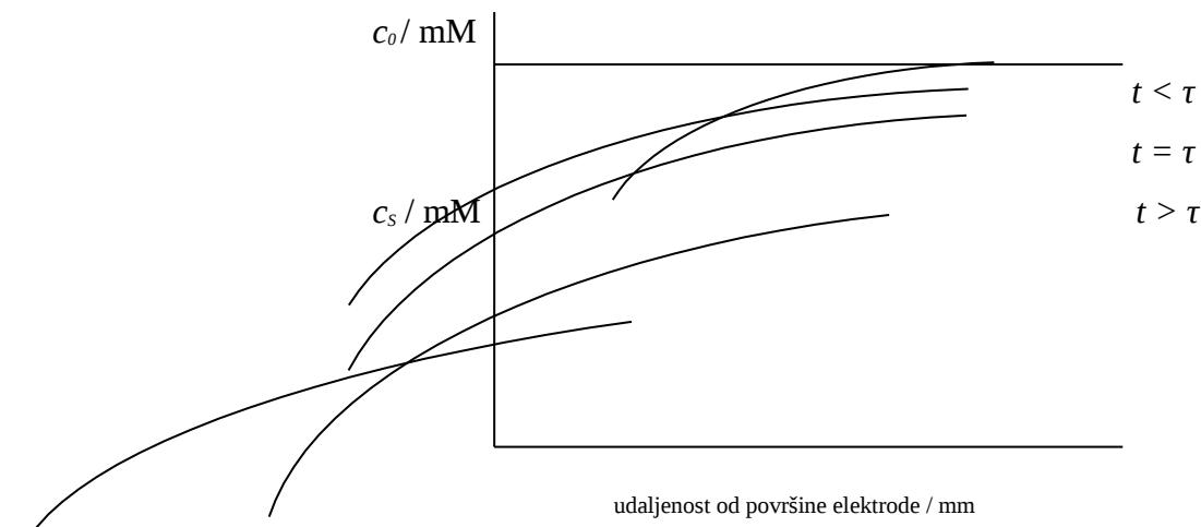
Slika 2.25 Koncentracijski profili za oksidirani oblik  $O$  elektrodne reakcije  $O + e^- \rightarrow R$  kao funkcija udaljenosti od površine elektrode sa koncentracijom u masi otopine  $c_0 / \text{mM}$  i koncentracijom na površini elektrode  $c_s / \text{mM}$
