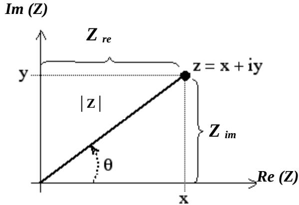
Slika 2.18 Argandov dijagram sa prikazom modula  $|Z|$ , kompleksnih brojeva  $Z_{re}$  i  $Z_{im}$  te faznog kuta  $\varphi$  kompleksnog broja  $Z$
