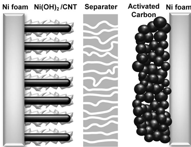
Slika 2.11 *Shema asimetričnog superkondenzatora sa  $\text{Ni}(\text{OH})_2/\text{CNT}$  anodom i AC katodom na podlozi od niklene pjene. Anoda pokazuje rekordni specifični kapacitet od  $3300 \text{ F g}^{-1}$*  [29]
