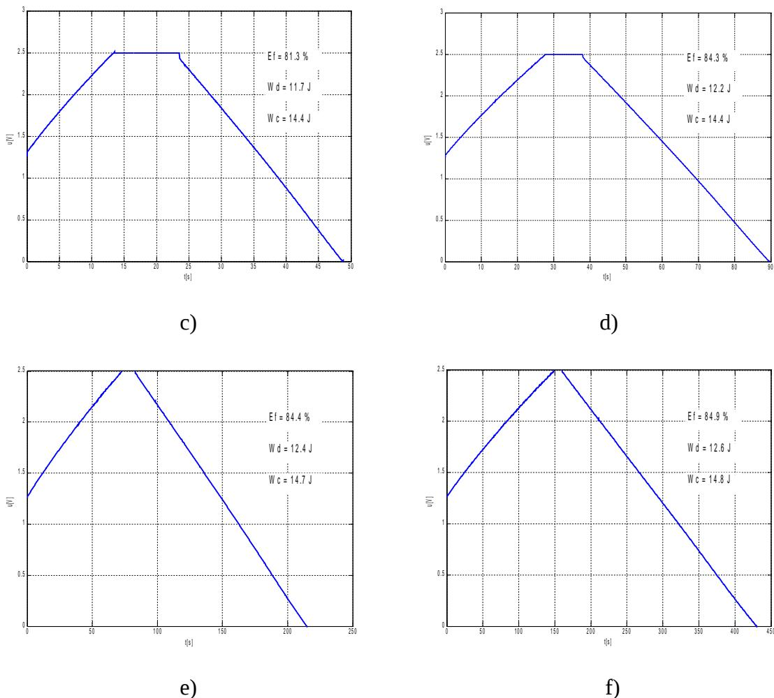
Slika 4.13a-f. Krivulje zadnja tri koraka ispitivanja energetske učinkovitosti pri šest različitim struja pražnjenja ( $I_d$ ) pri temperaturi od  $60\text{ }^{\circ}\text{C}$
