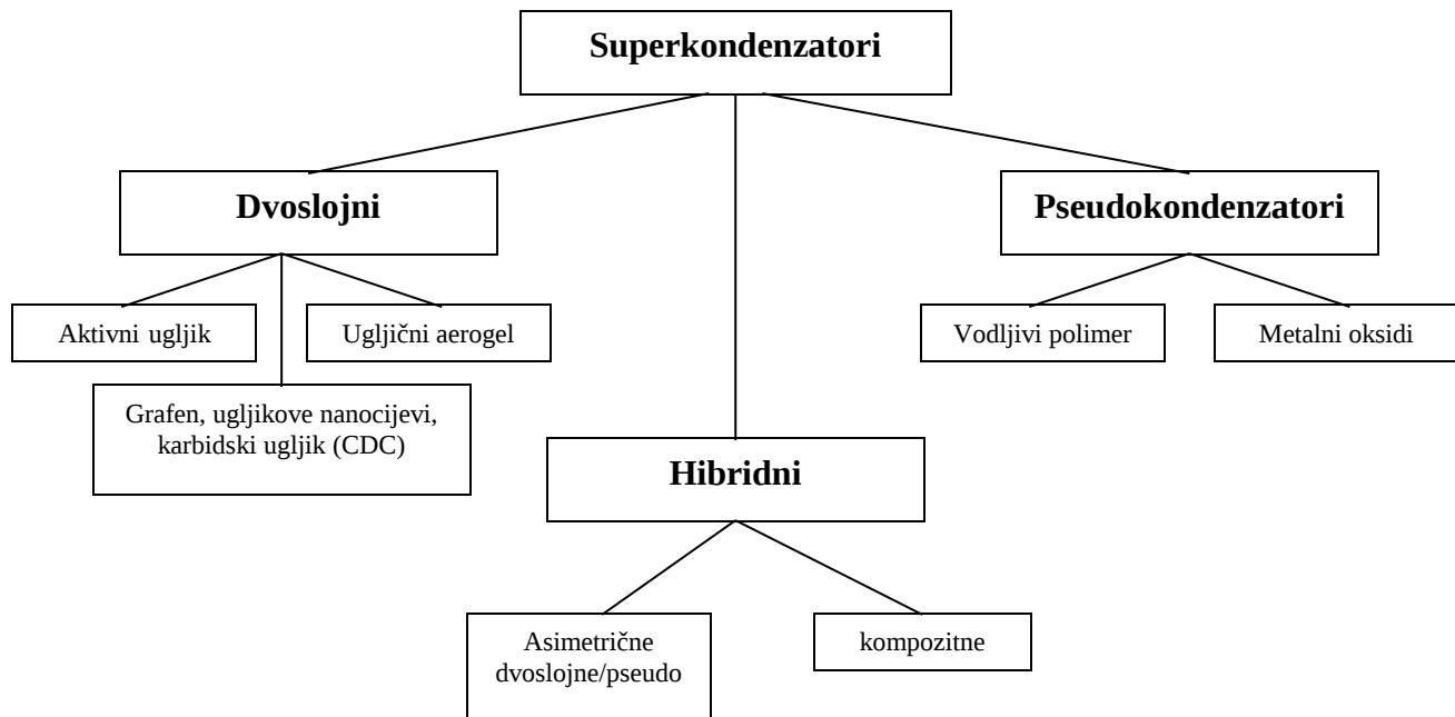
Slika 6. Vrste superkondenzatora sa grupama korištenih elektrodnih materijala
