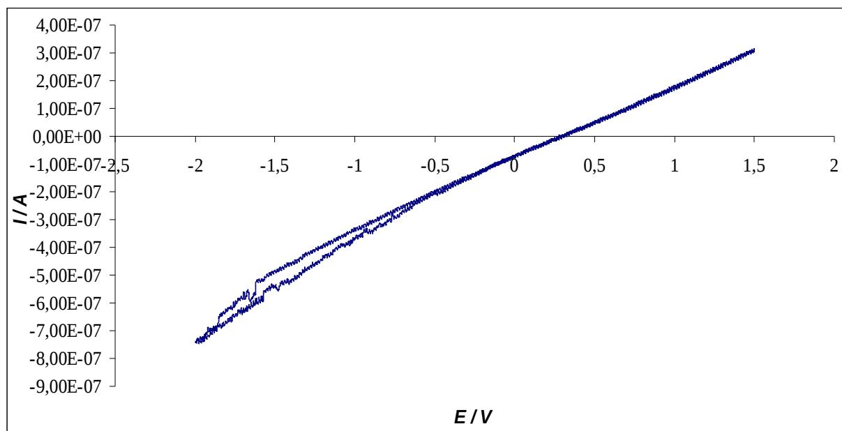
Slika 4.5 Ciklički voltamogram za elektrodu sa pripremljenim kompozitom u 0,1 M otopini  $\text{LiBF}_4$  u otapalu propilen karbonatu
