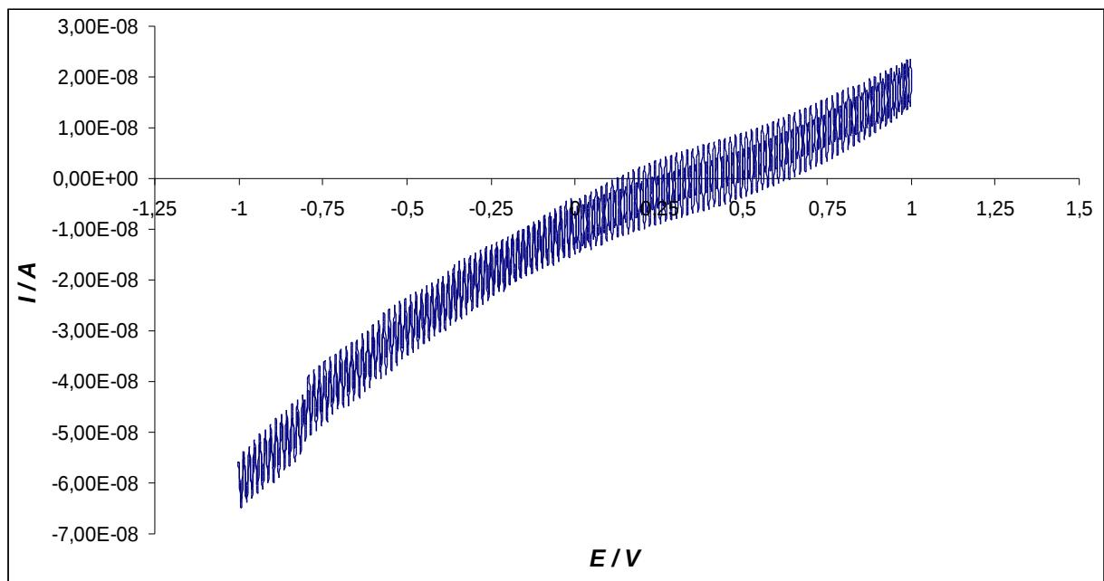
Slika 4.7 Ciklički voltamogram za elektrodu sa pripremljenim kompozitom u  $0,1 \text{ M}$  otopini  $\text{LiPF}_6$  u otapalu propilen karbonatu
