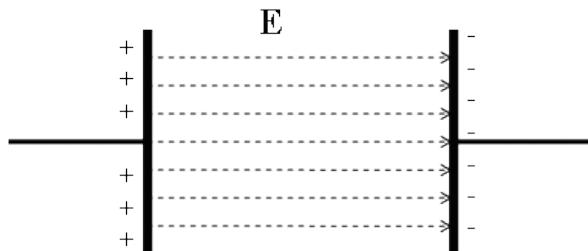
Slika 2.2 *Elektrostatski pločasti kondenzator sa dvije suprotno nabijene elektrode i električnim poljem jakosti  $E/Vm^{-1}$  koje djeluje kroz dielektrik u smjeru od pozitivne prema negativnoj elektrodi*
