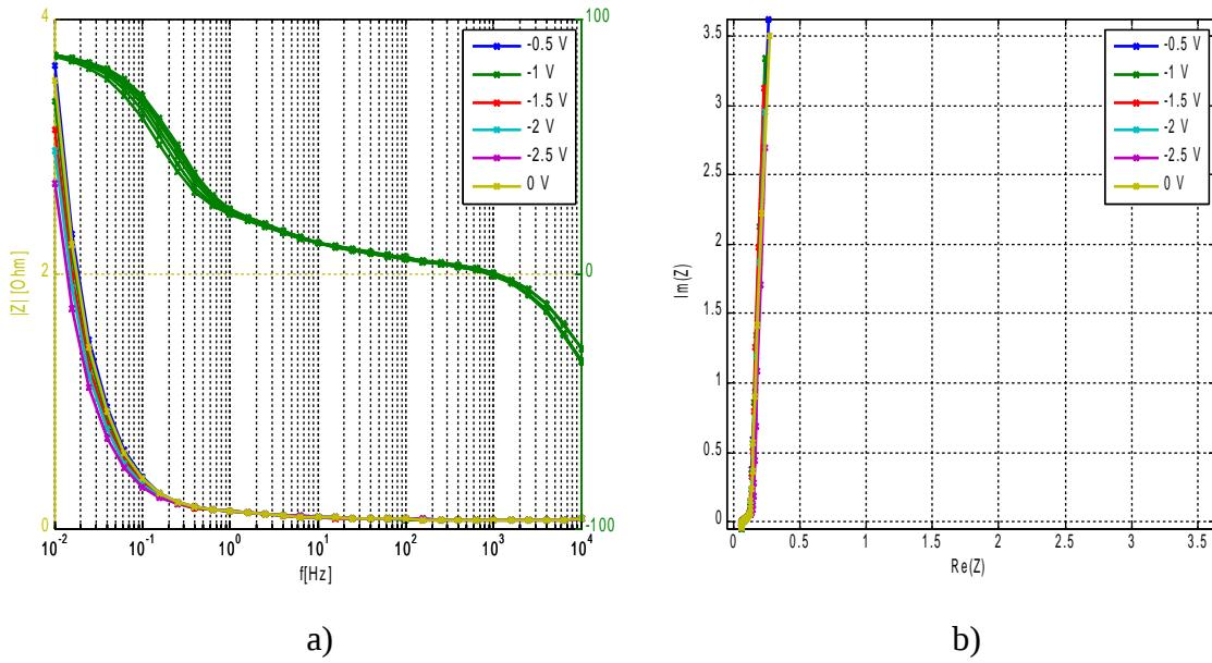
Slika 4.14a-b *Rezultati ispitivanja metodom elektrokemijske impedancijske spektroskopije (EIS) prikazani Bodeovim (lijevo) i Nyquistovim (desno) dijagramom pri 25 °C*
