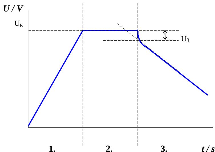
Slika 3.6 Napon-vrijeme karakteristika u kronopotenciometrijskom mjerenu za određivanje kapaciteta, unutarnjeg otpora i maksimalne gustoće snage. Brojevima 1, 2 i 3 dani su koraci koji se odvijaju prilikom mjerena; 1 – galvanostatsko punjenje , 2 – potenciostatsko punjenje 3 – galvanostatsko pražnjenje
