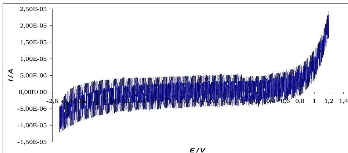
Slika 4.2. Ciklički voltamogram za Al elektrodu u  $0,1 \text{ M}$  otopini  $\text{LiBF}_4$  u smjesi otapala propilen karbonata i etilen karbonata pomiješanih u volumnom omjeru 50:50
