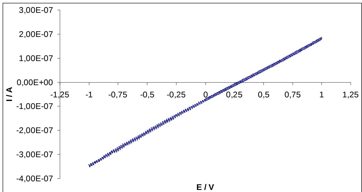
Slika 4.8 Ciklički voltamogram za elektrodu sa pripremljenim kompozitom u  $0,1 \text{ M}$  otopini  $\text{LiPF}_6$  u smjesi otapala propilen karbonata i etilen karbonata koji su pomiješani u volumnom omjeru 50:50
