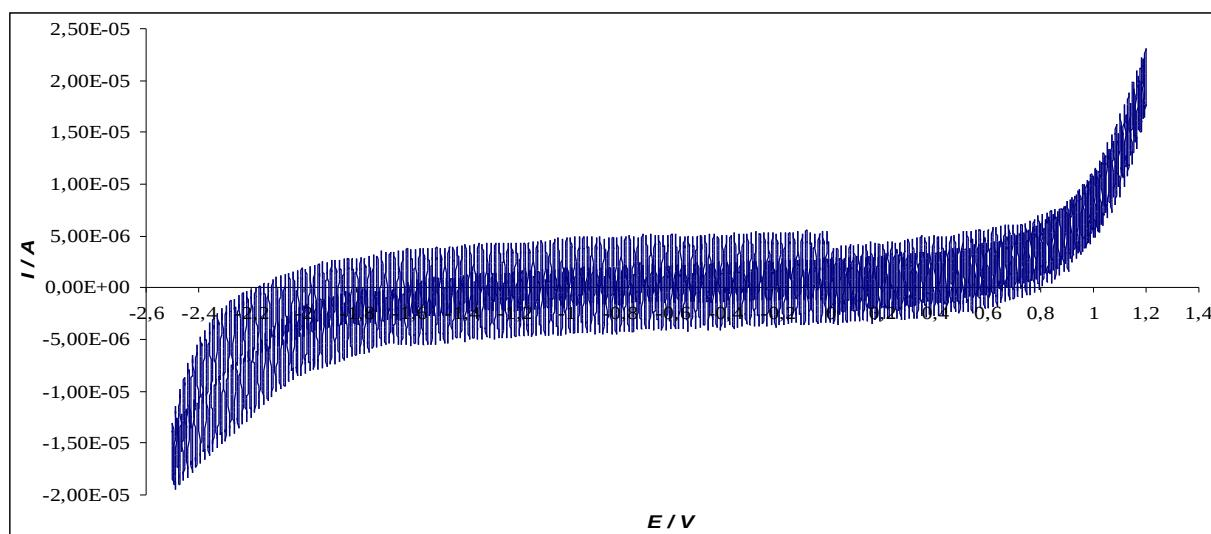
Slika 4.1. Ciklički voltamogram za Al elektrodu u  $0,1 \text{ M}$  otopini  $\text{LiBF}_4$  u otapalu propilen karbonatu
