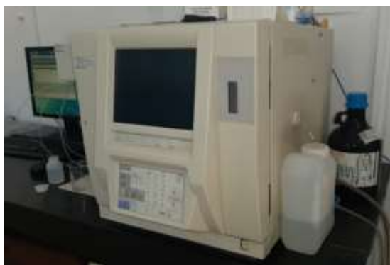
Slika 3. TOC analizator Shimadzu TOC-V WS (Japan)
