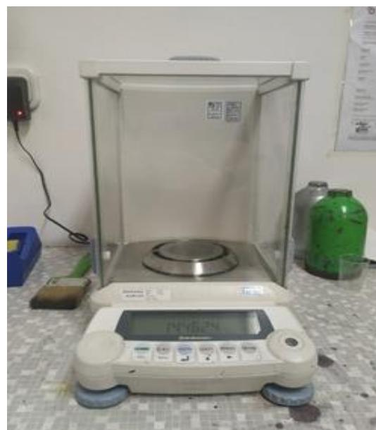
**Slika 3.1** Analitička vaga proizvođača *Shimadzu*
