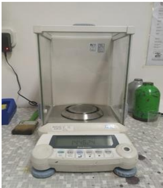
Slika 3.1 Analitička vaga proizvođača Shimadzu
