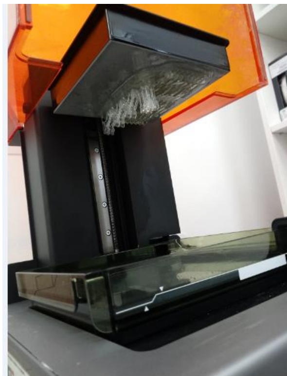
Slika 25. Form 2 3D-pisač proizvođača Formlabs sa ispisanim modelima epruveta
