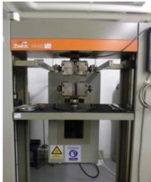
Slika 28. Univerzalna mehanička kidalica 1445, proizvođača Zwick Röell
