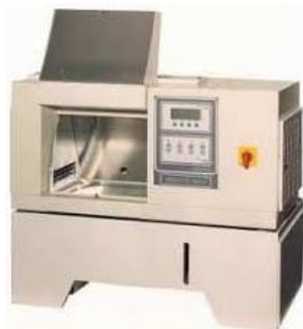
Slika 27. Komora za starenje za naknadno očvršćivanje epruveta
