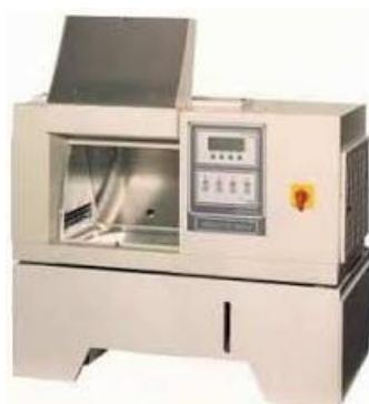
Slika 27. Komora za starenje za naknadno očvršćivanje epruveta
