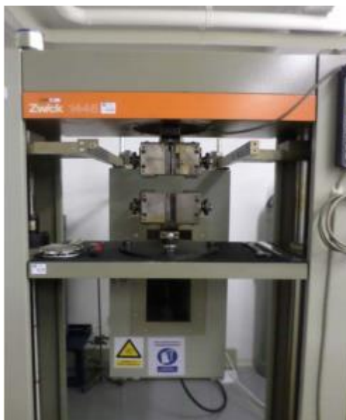
Slika 28. Univerzalna mehanička kidalica 1445, proizvođača Zwick Röell
