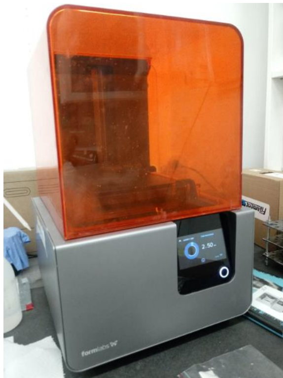
Slika 24. Form 2 3D-pislać proizvođaća Formlabs
