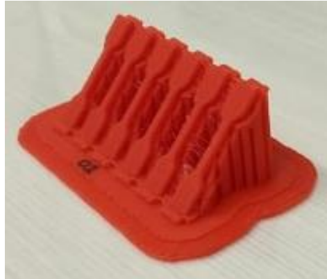
Slika 17. Uzorci epruveta ispisanе pod kutom od 45°, položene na potpornom materijalu
