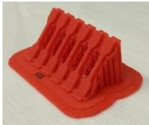
Slika 17. Uzorci epruveta ispisane pod kutom od  $45^\circ$ , položene na potpornom materijalu
