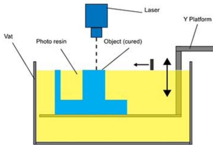
Slika 1. Mehanizam fotopolimerizacije
