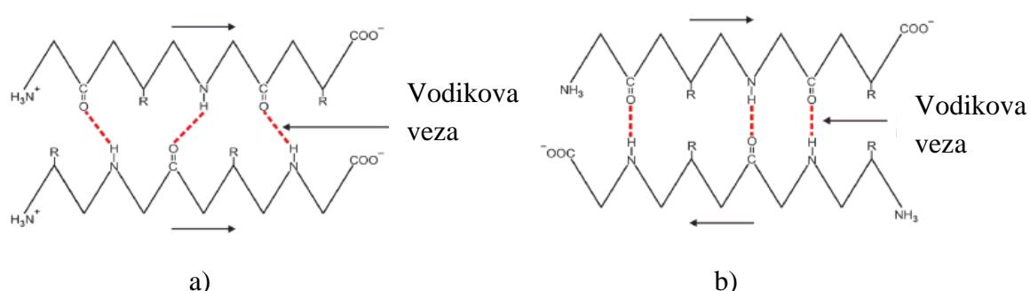
**Slika 2.5.** Prikaz strukture a) paralelne i b) antiparalelne  $\beta$ -naborane ploče (Naik, 2011)
