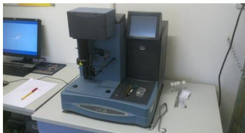
**Slika 11.** TGA analizator Q500, TA Instruments
