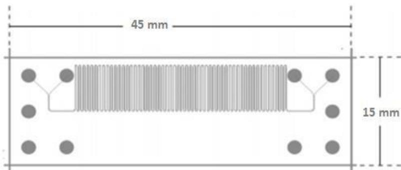
*Slika 2. Shematski prikaz unutarnje građe mikroreaktora [4]*
