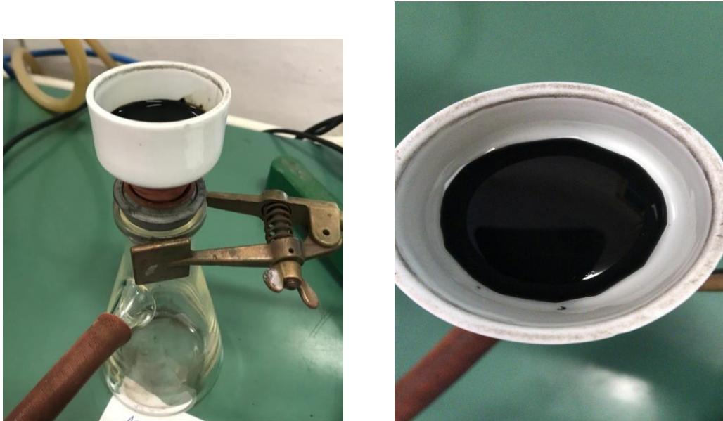
Slika 3.3. Vakuum filtracija
