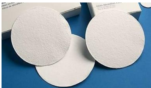
Slika 3.2. Filter papir korišten pri vakuum filtraciji čija je veličina pora 100 nm
