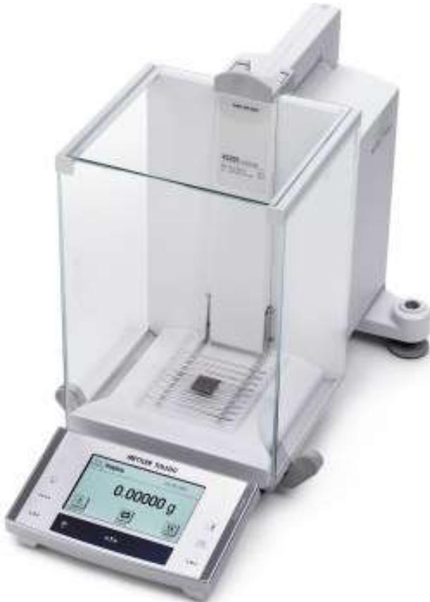
**Slika 7.** Analitička vaga XS204 Delta Range, Mettler Toledo
