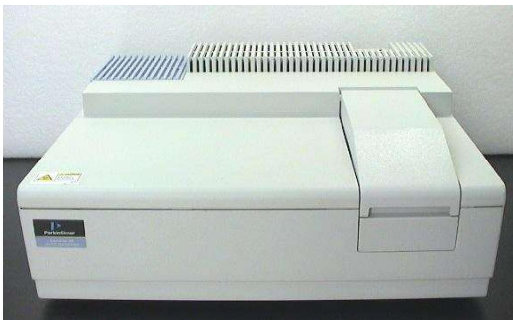
**Slika 8.** Spektrofotometar PerkinElmer Lambda 35
