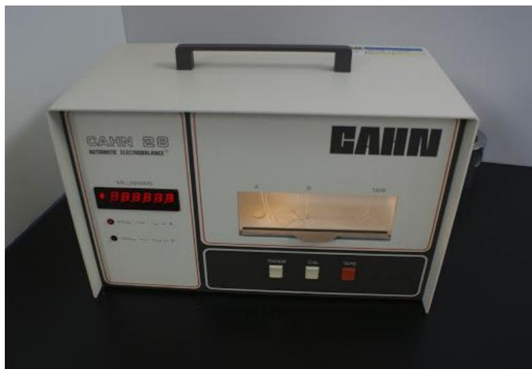
Slika 4: Cahn C- microbalance uređaj
