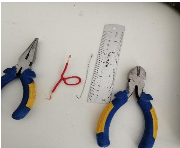
Slika 10: Prikaz žice sa izolacijom i tanke metalne žice
