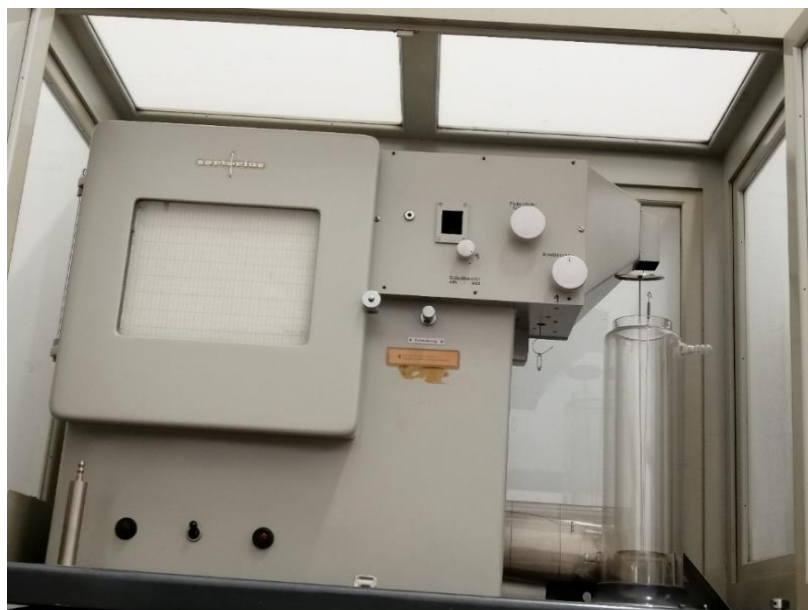
Slika 6: Prikaz originalne aparature za određivanje mase u ovisnosti o vremenu sedimentacije.
