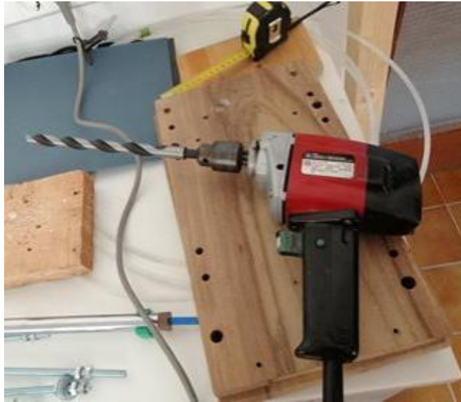
Slika 11: Prikaz drvene daske s rupama za metalne šipke
