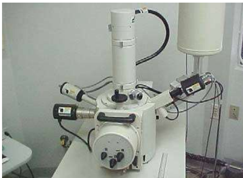
Slika 15. SEM uređaj s karakterističnim detektorima
