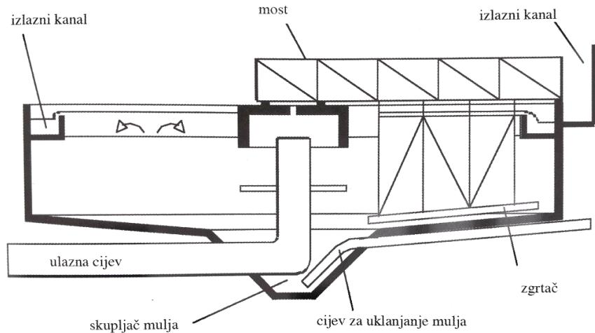
Slika 4. Shema kružnog taložnika <sup>(1)</sup>
