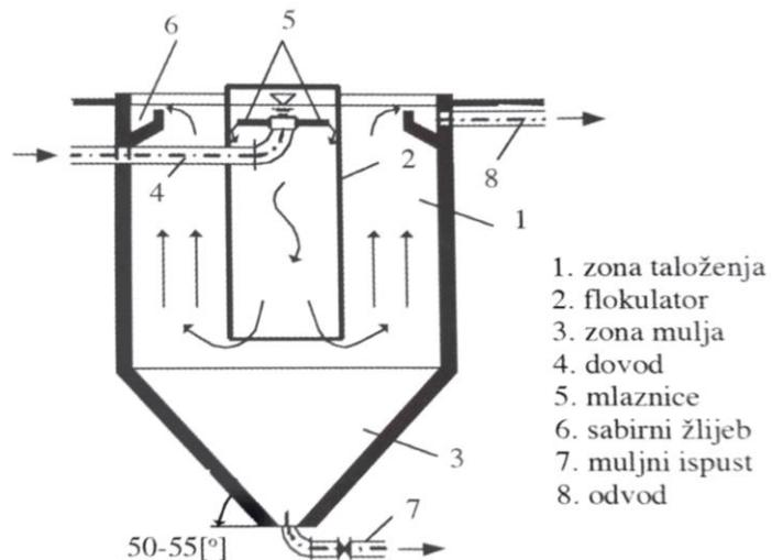
Slika 5. Taloznik s vertikalnim tokom vode <sup>(1)</sup>
