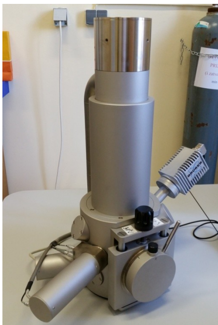
Slika 23. Pretražni elektronski mikroskop, Tescan Vega serija 3, Bruker
