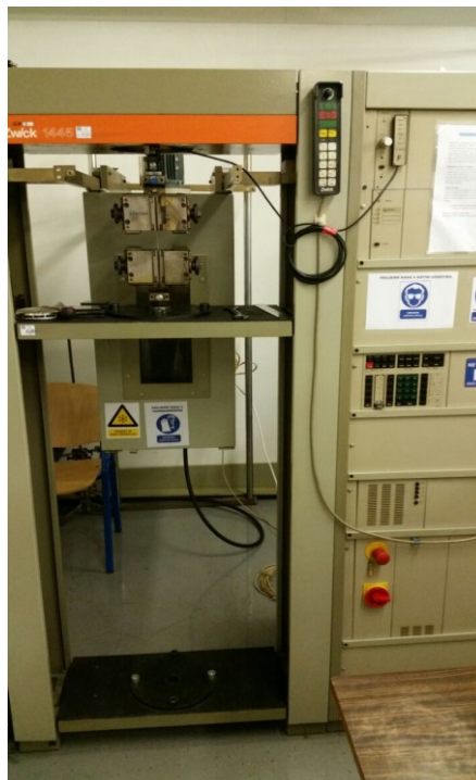
Slika 22. Univerzalni stroj za mehanička ispitivanja, Zwick 1445
