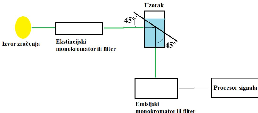
**Slika 5.** Shematski prikaz UV-vid fluorescencijskog spektrofotometra.
