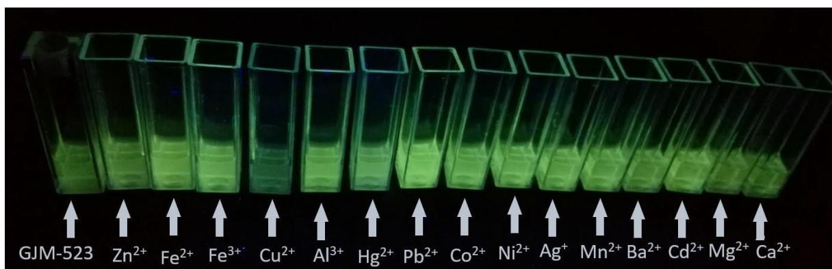
**Slika 22.** GJM-523 u prisutnosti metalnih iona u otopini MeOH/pufer pH 5,50 (v/v, 1/2).
