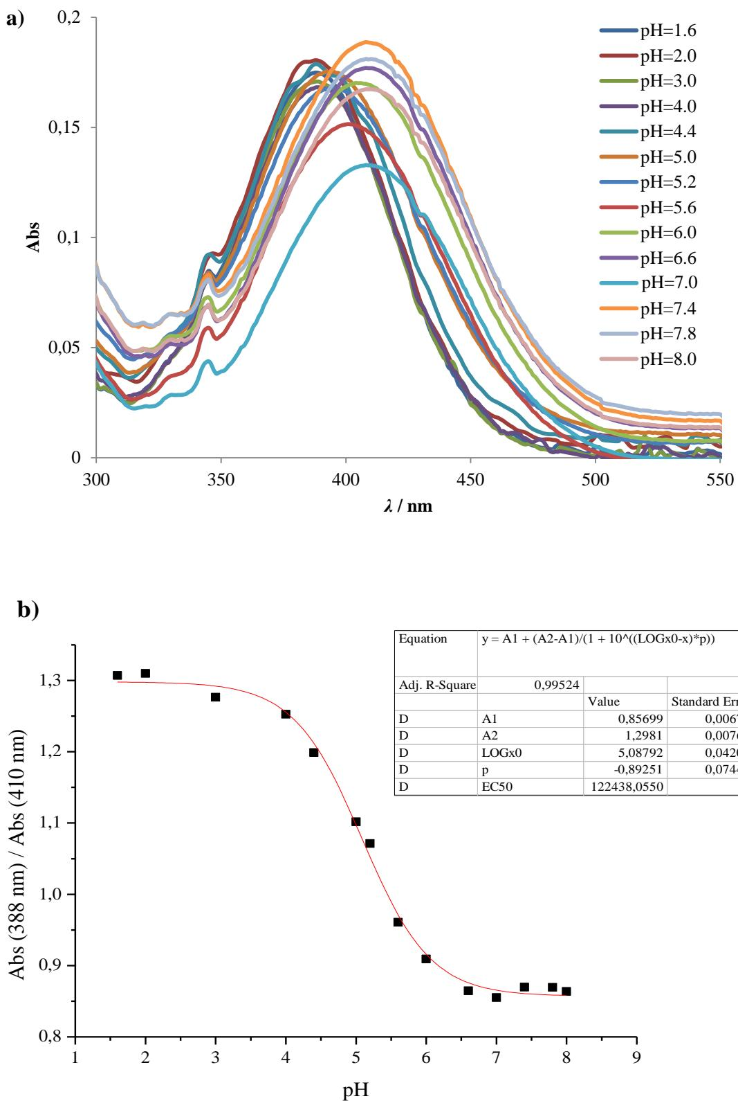
**Slika 17.** Spoj **GJM-523** ( $6,56 \times 10^{-5}$  M) u otopini MeOH/pufer (v/v, 1/2) a) apsorpcijski spektri pri različitim pH vrijednostima u otopini MeOH/pufer (v/v, 1/2) b) krivulja ovisnosti omjera apsorbancije pri 388 nm i 410 nm o pH vrijednosti otopine.
