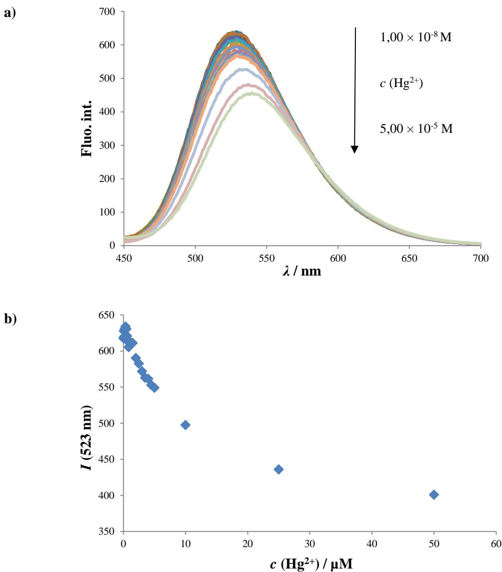
**Slika 26.** a) Emisijski spektri otopine **GJM-523** ( $5,00 \times 10^{-7}$  M) u MeOH/pufer pH 5,50 (v/v, 1/2) u rasponu koncentracija Hg<sup>2+</sup> iona  $5,00 \times 10^{-8}$  M -  $5,00 \times 10^{-5}$  M. b) Ovisnost intenziteta fluorescencije otopine **GJM-523** ( $5,00 \times 10^{-7}$  M) u MeOH/pufer pH 5,50 (v/v, 1/2) pri 523 nm u rasponu koncentracija Hg<sup>2+</sup> iona  $5,00 \times 10^{-8}$  M -  $5,00 \times 10^{-5}$  M.
