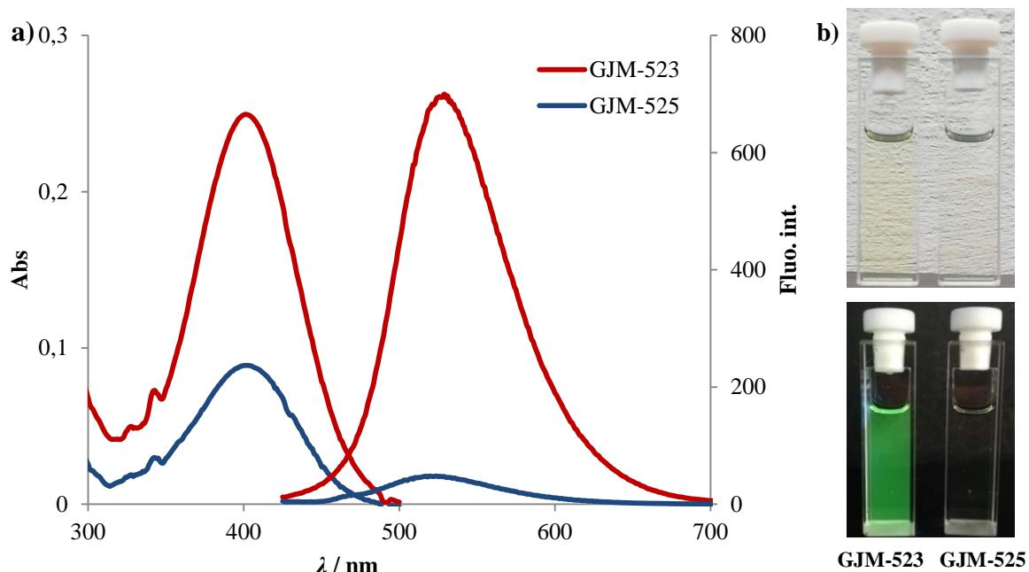
**Slika 16.** a) apsorpcijski i fluorescencijski (emisijski) spektri b) otopine spojeva **GJM-523** i **GJM-525** u metanolu ( $c = 1,00 \times 10^{-5}$  M) pod danjim svjetlom (gore) i pod UV svjetlom (365 nm) (dolje),  $\lambda_{exc} = 410$  nm.
