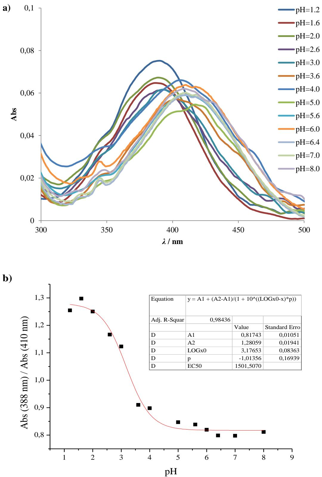
**Slika 18.** Spoj **GJM-525** ( $6,54 \times 10^{-5}$  M) u otopini MeOH/pufer (v/v, 1/2) a) apsorpcijski spektri pri različitim pH vrijednostima u otopini MeOH/pufer (v/v, 1/2) b) krivulja ovisnosti omjera apsorbancije pri 388 nm i 410 nm o pH vrijednosti otopine.
