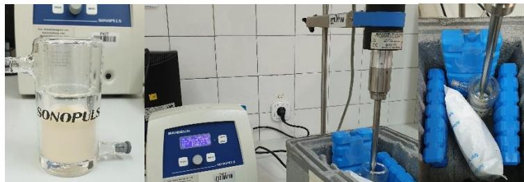
**Slika 3.5.** Aparatura za sonifikaciju
