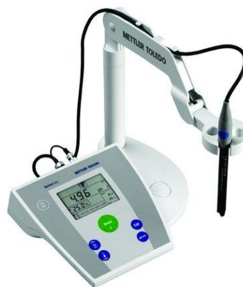
Slika 3.4. pH metar Mettler Toledo S20 SevenEasy [28]
