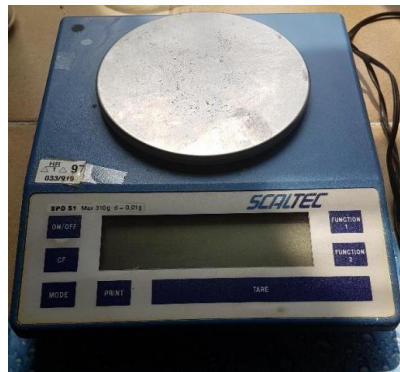
Slika 3.3. Tehnička vaga Scaltec SP0 51 [27]
