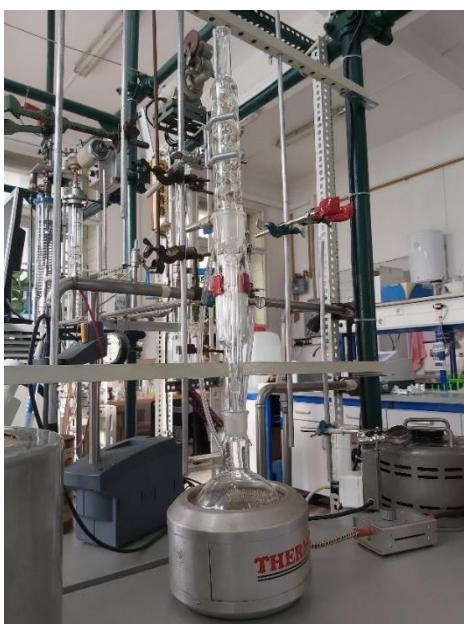
**Slika 16.** Aparatura za Soxhlet ekstrakciju
