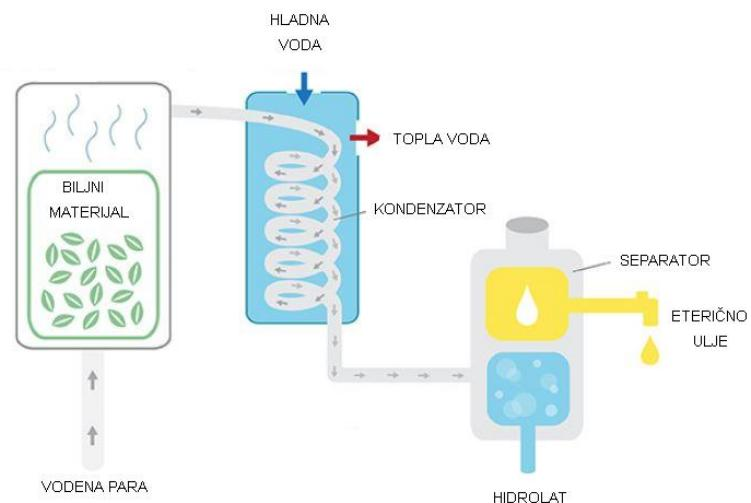
**Slika 2.** Shematski prikaz procesa destilacije vodenom parom [7].
