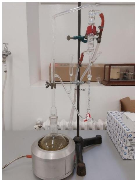
**Slika 15.** Aparatura za hidrodestilaciju
