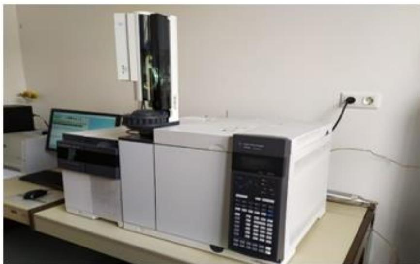
**Slika 18.** Plinski kromatograf sa spektrometrijom masa (GC-MS).
