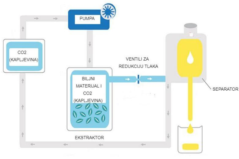
**Slika 5.** Shematski prikaz procesa ekstrakcije superkritičnim CO<sub>2</sub> [7].
