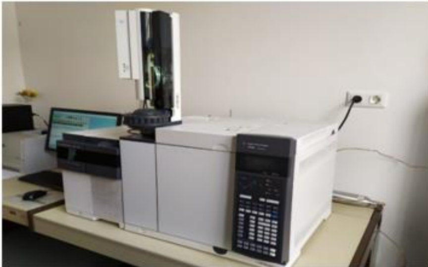
Slika 18. Plinski kromatograf sa spektrometrijom masa (GC-MS).
