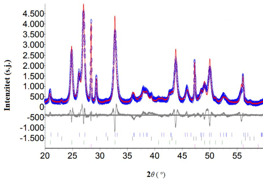
*Slika 9.* Rietveldova analiza difraktograma  $\text{CaCO}_3$  dopiranog silicijem ( $\text{CaCO}_3\text{-Si2}$ ).
