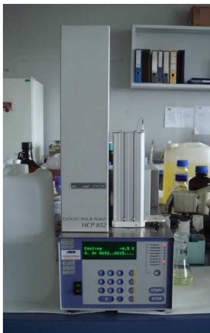
Slika 9. Automatski analizator za određivanje točke tečenja i točke zamućenja (Herzog HCP 852)
