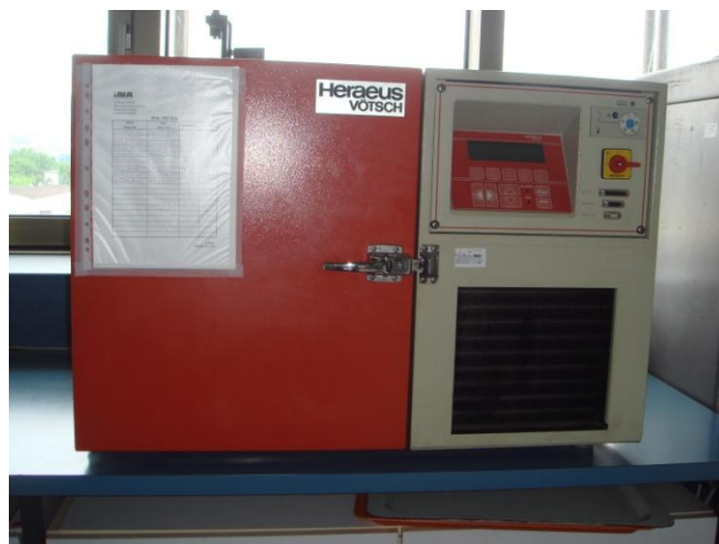
Slika 11. Komora za programirano hlađenje Heraeus-Vötsch 07/35
