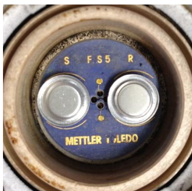
Slika 13. Mjerno osjetilo FRS 5
