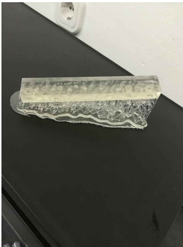
Slika 16. Milireaktor V2 s potpornim stupovima
