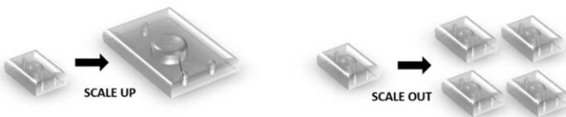
Slika 9. Pojednostavljeni prikaz uvećanja mikrosustava (engl. scale out )
