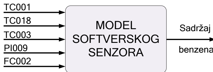
Slika 9 Struktura modela softverskog senzora s odabranim ulaznim veličinama
